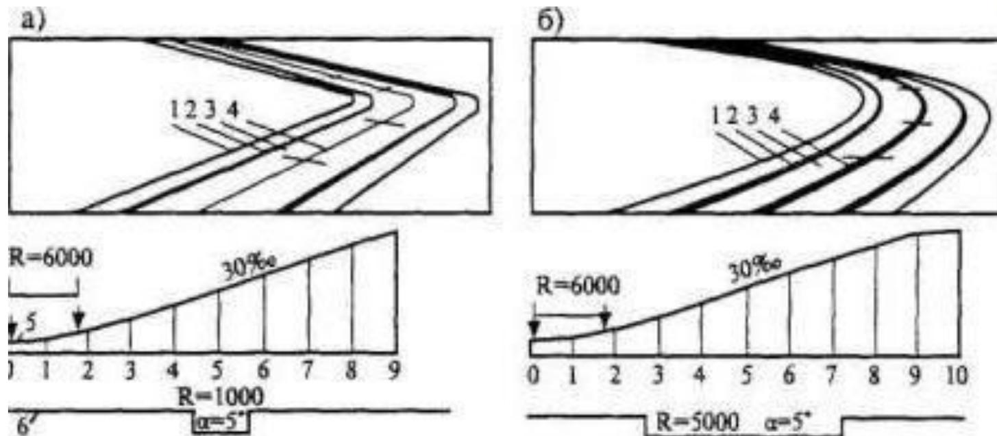
**Рис. 5.** Изменение вида дороги в зависимости от радиуса кривой в плане при малом угле поворота:
