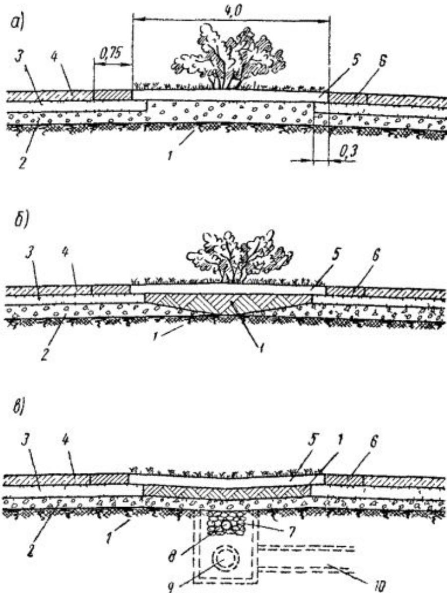
а - с о сплошным крупнозернистым слоем; б - с прерванным крупнозернистым с лоем; в - с отводом воды подполосны м дренажом; 1 - г рунт земляного полотна; 2 - к рупнозерн исты й хорошо дренирующий материал; 3 - о снован ие из щебня или грунта, обработанного вяжущими материалами; 4 - цемен тобетонн ое покрытие; 5 - р асти тельный слой; 6 - к раевая полоса; 7 - к аменная засыпка; 8 - п одполосная дрена для от вода воды из дренирующего слоя; 9 - к оллектор; 10 - о тводная труба
