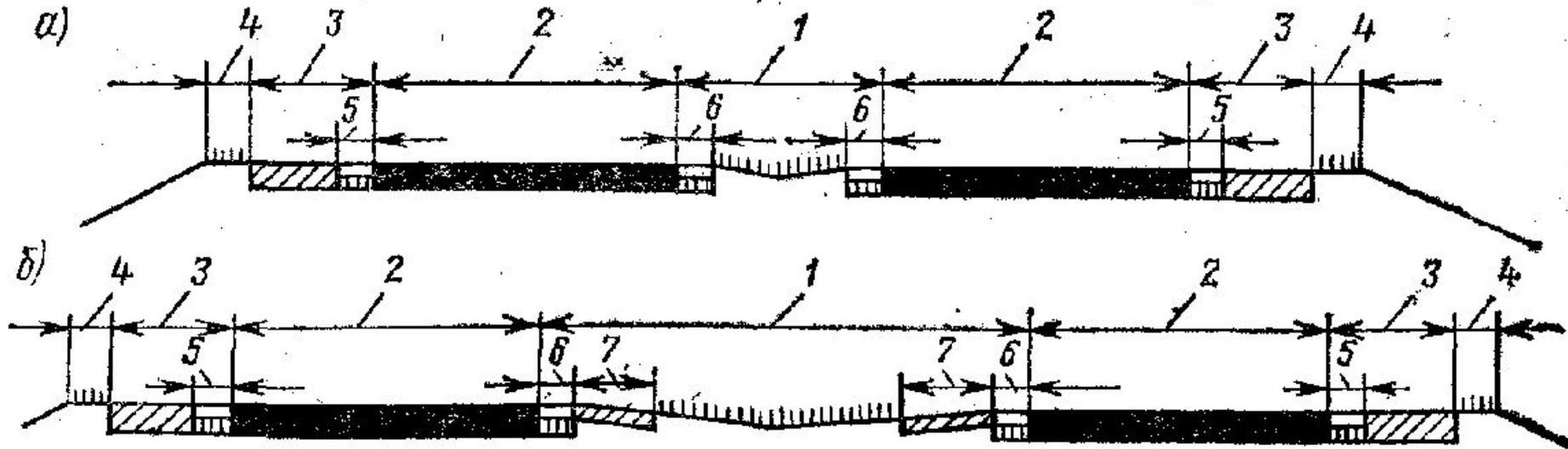
Рис. XXXIV.4. Элементы поперечного профиля современных автомобильных магистралей:
