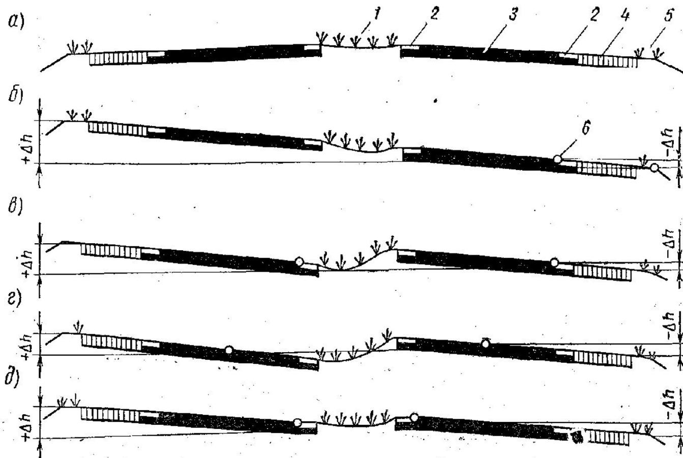
*a* — поперечный профиль на прямых участках; *б* — поворот поперечного профиля относительно бровки земляного полотна или внутренней кромки внутреннего покрытия; *в* — поворот проезжих частей относительно их внутренних кромок; *г* — поворот проезжих частей относительно их осей; *д* — поворот проезжих частей относительно кромок, прилегающих к разделительной полосе;
