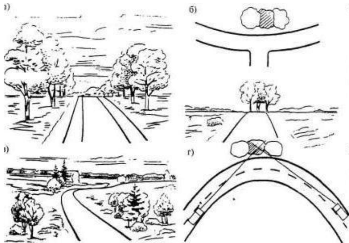
**Рис. 8.** Обозначение направления дороги вершинами деревьев:
