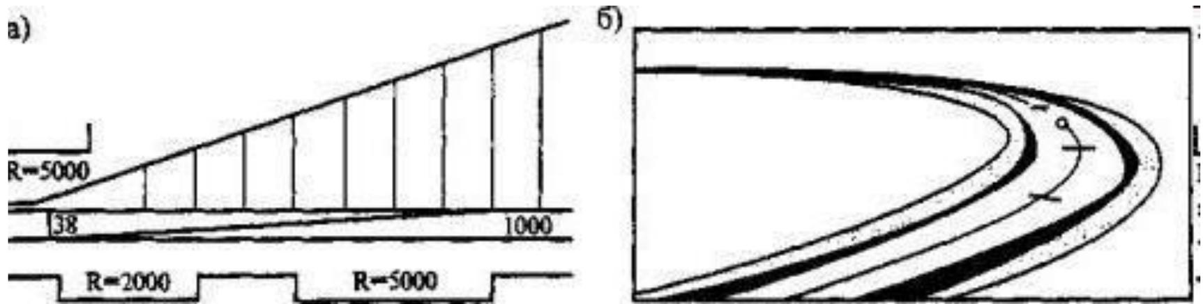
**Рис. 6.** Вид участка дороги с короткой прямой вставкой между двумя кривыми, направленными в одну сторону:
