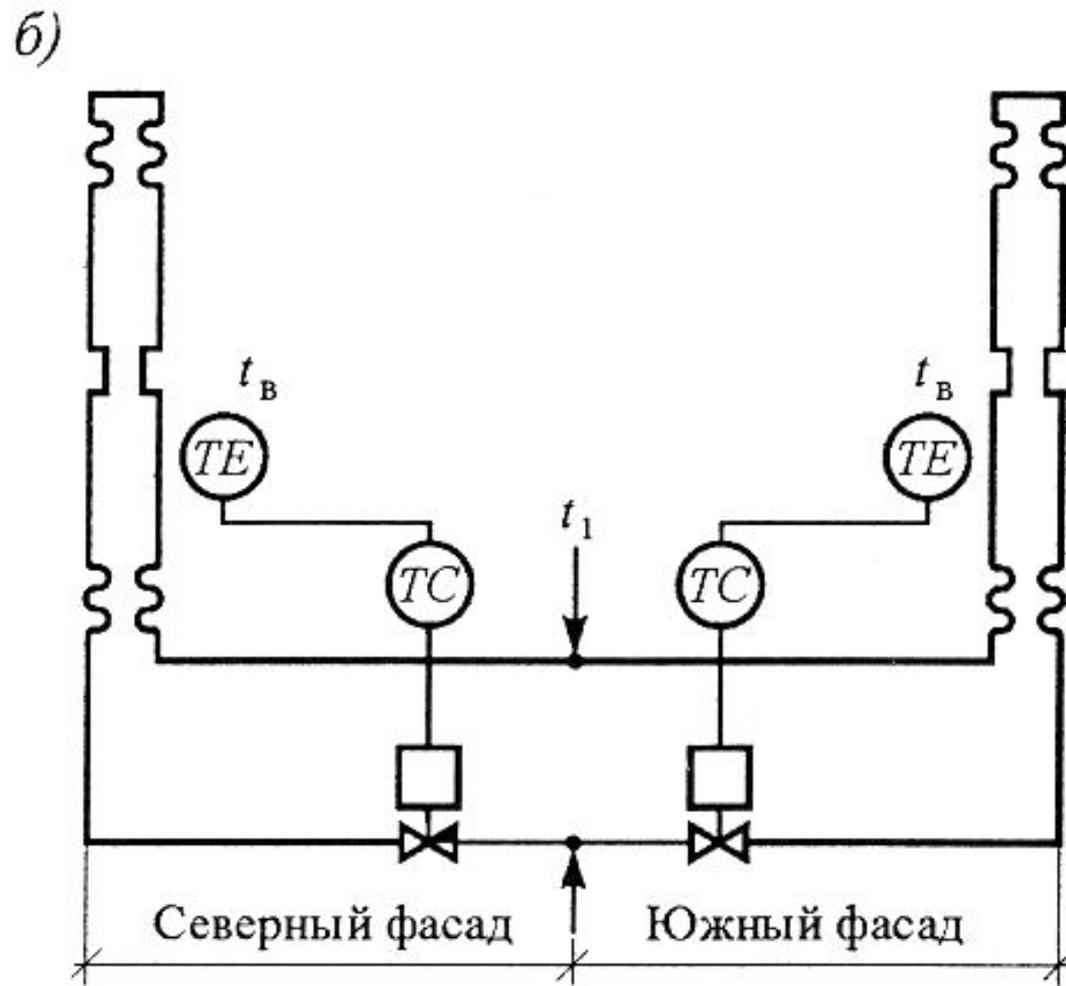
Схемы местного (а) и пофасадного (б) регулирования отпуска теплоты на отопление по отклонению температуры воздуха помещений
