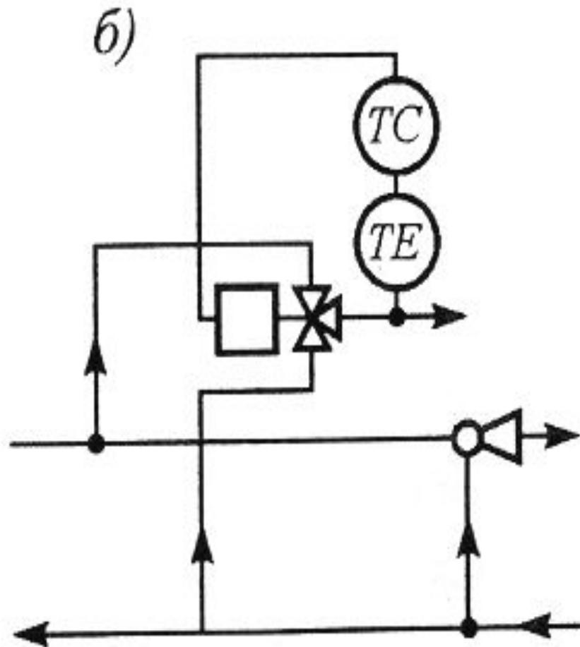
**Схемы автоматического регулирования температуры воды горячего водоснабжения при открытой системе теплоснабжения с двухходовым (а) и с трехходовым регулирующим клапаном (б).**
