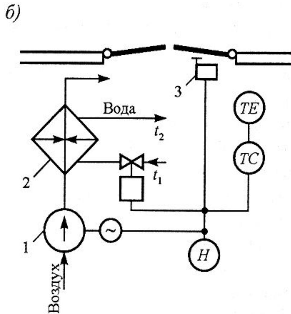
**Схема автоматизации установок воздушного отопления (а) и воздушно-тепловой завесы (б): 1 - вентилятор; 2 - воздухоподогреватель; 3 - концевой выключатель**
