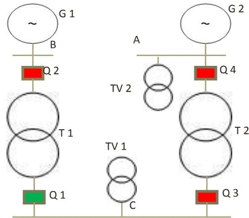
На ряду с отключением Q1 следует иметь в виду возможность отключения выключателя Q2 со стороны высокого напряжения рабочего трансформатора. В этом случаи потребители также потеряют питание. Для того чтобы обеспечить действие АВР и в этом случаи при отключении Q2 от его вспомогательного контакта SQ 2,2 подается импульс на катушку отключения YAT 1 выключателя Q1. После отключения Q1 АВР запускается и действует как рассмотрено выше.
