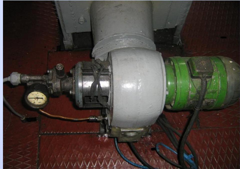
1 – электродвигатель; 2 – вентилятор; 3 – фотоэлемент; 4 – электроды; 5 – форсунка; 6 – электромагнитные клапаны; 7 – высоковольтный трансформатор; 8 – штуцер для слива топлива; 9 – шестеренный топливный насос; 10 – штуцер для подвода топлива; 11 – топливный золотник; 12 – шибер, регулирующийся автоматически; 13 – шибер регулирующийся вручную; 14 – рукоятка ручной регулировки шибера; 15 – ограничительные упоры; 16 – электрический исполнительный механизм.
