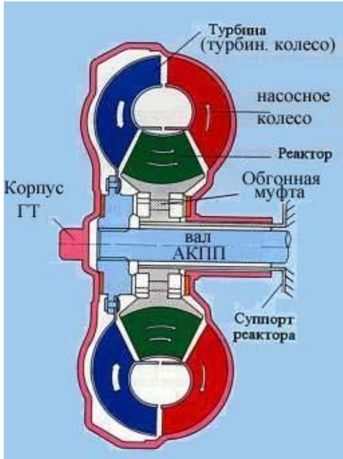
Насосное колесо связано с коленчатым валом двигателя, а турбина – с валом коробки передач. Тем самым в гидротрансформаторе отсутствует жесткая связь между ведущими и ведомыми элементами, а передача энергии от двигателя к трансмиссии осуществляется потоками рабочей жидкости, которая отбрасывается с лопаток насоса на лопасти турбины.
