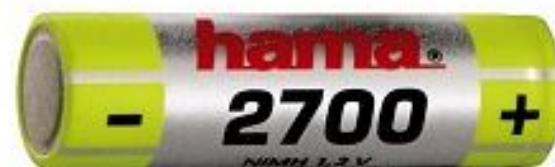
Рис. 3. Обозначение ёмкости в мА*ч.
