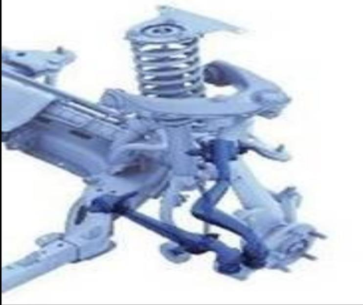
Многорычажная подвеска несколько напоминает двухрычажную подвеску и имеет все ее положительные качества. Эти подвески более сложны и более дороги, но обеспечивают большую плавность хода и лучшую управляемость автомобиля. Большое количество элементов - сайлент-блоков и шаровых шарниров хорошо гасят удары при резком наезде на препятствия. Все элементы крепятся на подрамнике через мощные сайлент-блоки, что позволяет увеличить шумоизоляцию автомобиля от колес.
