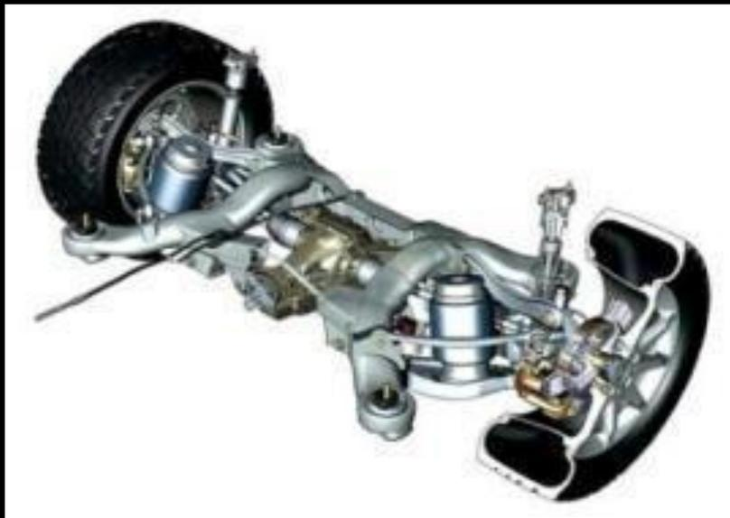
Но несмотря на совершенствование конструкции, все зависимые подвески обладают одним и весьма существенным минусом: проявляется несбалансированное поведение автомобиля при старте и торможении. Машина начинает "приседать" при интенсивном разгоне и "клевать носом" во время торможения. Для устранения этого эффекта стали применять дополнительные направляющие элементы.
