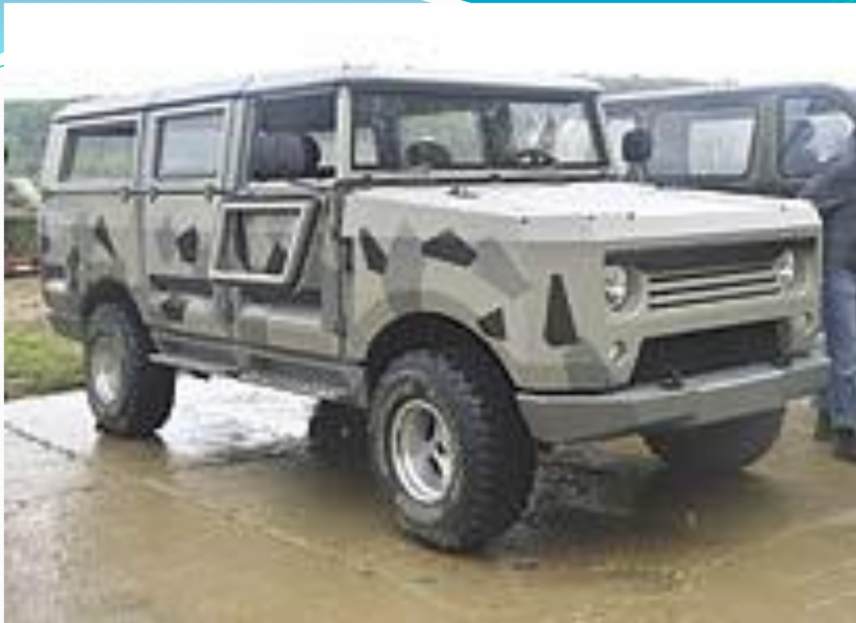
Макет УАЗ модульной конструкции с возможностью скрытого бронирования
