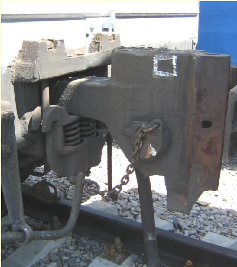
Для 8-ми осных вагонов и вагонов с длинной базой применены возвращающие устройства для снижения изгибающих сил (при проходе горба сортировочной горки)
