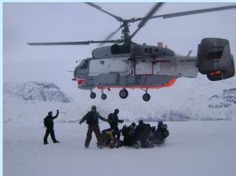
Вертолетная авиация в ходе проведения ПСР может работать с неподготовленных площадок. Преимуществом обладают вертолеты с соосной схемой винтов. При планировании спасательной операции необходимо учитывать, что во время приземления на неподготовленную площадку двигатели не выключаются.
