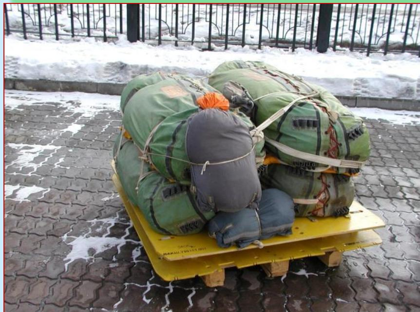
Данный вариант АСК предназначен для экстренной доставки групповых спасательных плавсредств терпящим бедствие на акваториях Мирового океана методом десантирования. Максимальное количество десантируемых платформ - 26, по четыре плота типа ПСН-10МК на каждой.
