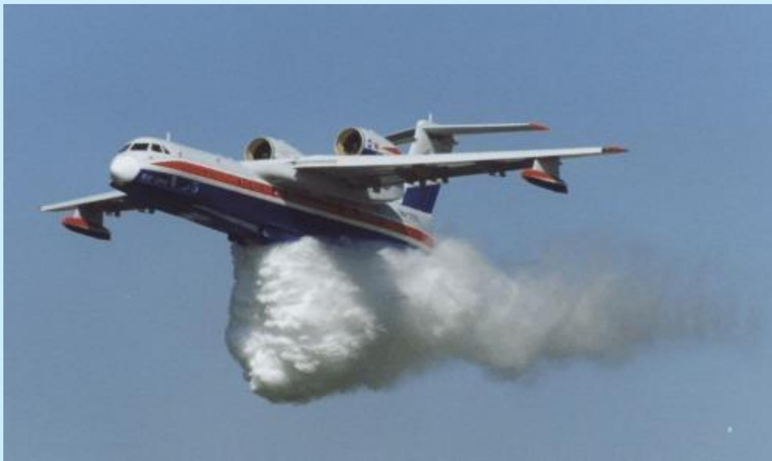
Кроме того, самолет-амфибия Бе-200ЧС применяется для тушения ландшафтных пожаров. Он способен на глиссировании забирать в емкости 12 т воды за 12-14 секунд.
