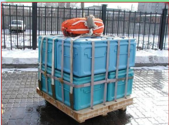
Десантирование оборудования и снаряжения аэромобильного госпиталя производится на тяжелых грузовых платформах П-7 с высоты 500-800 метров или на парашютно-грузовых системах ПГС-1000 с высот 150-200 метров
