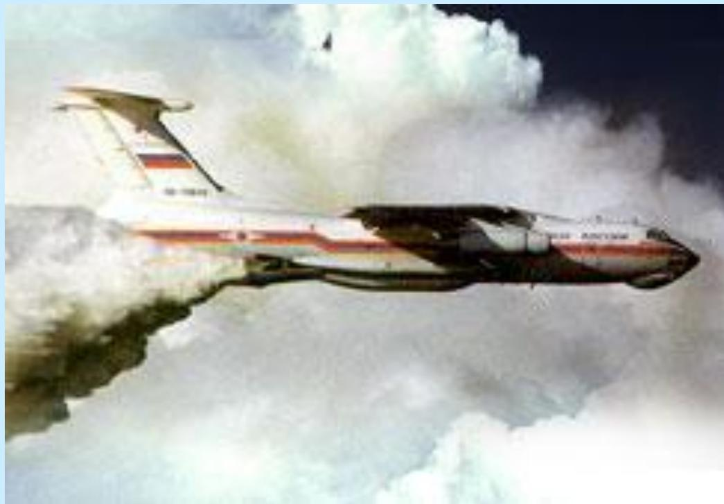
Предназначен для тушения площадных пожаров для чего используются выливные авиационные приборы ВАП-2, с борта самолета Ил-76ТД и представляющие собой легкоъемную, монтируемую в грузовой кабине самолета танкерную систему, заполненную огнегасящей жидкостью
