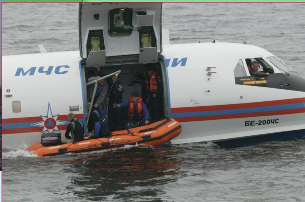
Многоцелевой самолет-амфибия Бе-200ЧС предназначен для проведения поисково-спасательных работ на акваториях внутренних вод и территориального моря, а также для перевозки спасателей и грузов, эвакуации пострадавших с поверхности акватории.
