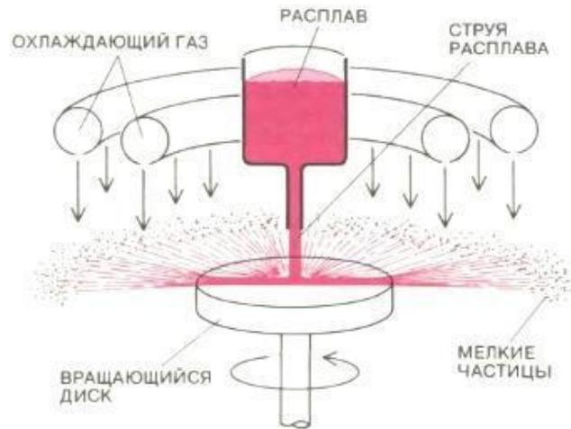
б РАСПЫЛЕНИЕ С ПОМОЩЬЮ ИНЕРТНОГО ГАЗА
