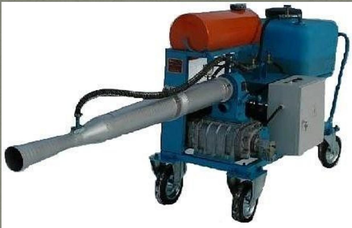
Оборудование генератора смонтировано на ручной трехколесной тележке. На ее платформе установлены: воздушный нагнетатель, приводимый в рабочее состояние от электродвигателя через клиноременную передачу; горелка с камерой сгорания и жаровой трубой; баки для рабочей жидкости, топливный и для воды; электрощит. В комплект генератора входят: механический распылитель и огнетушитель.
