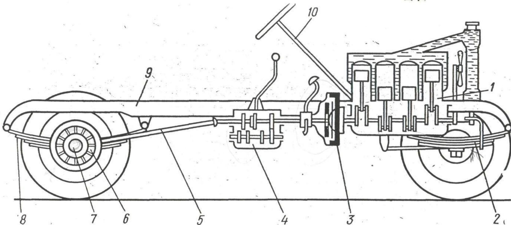
Рис.1. Схема расположения основных агрегатов и механизмов на автомобиле
