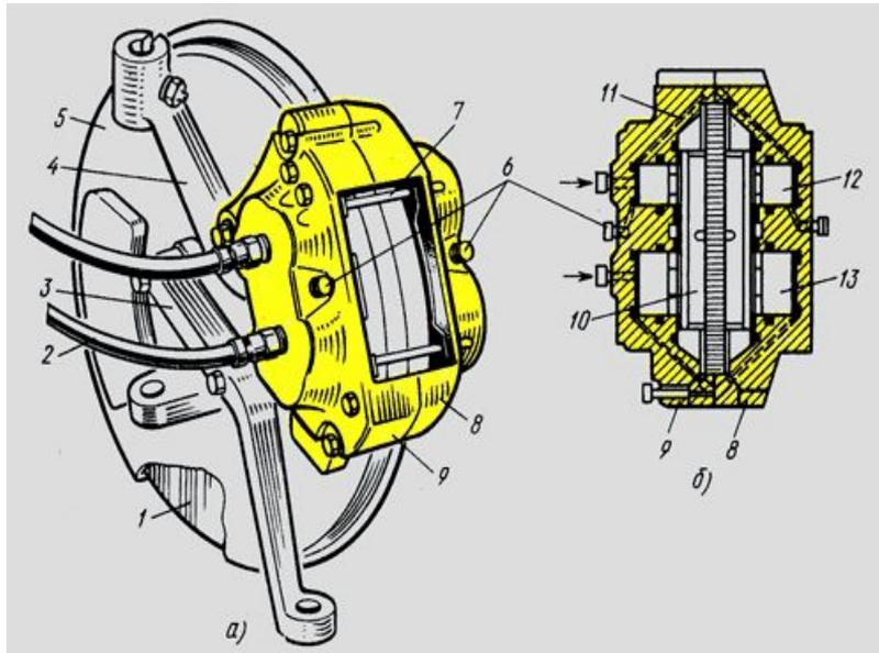
Рис. Колесный дисковый тормозной механизм
