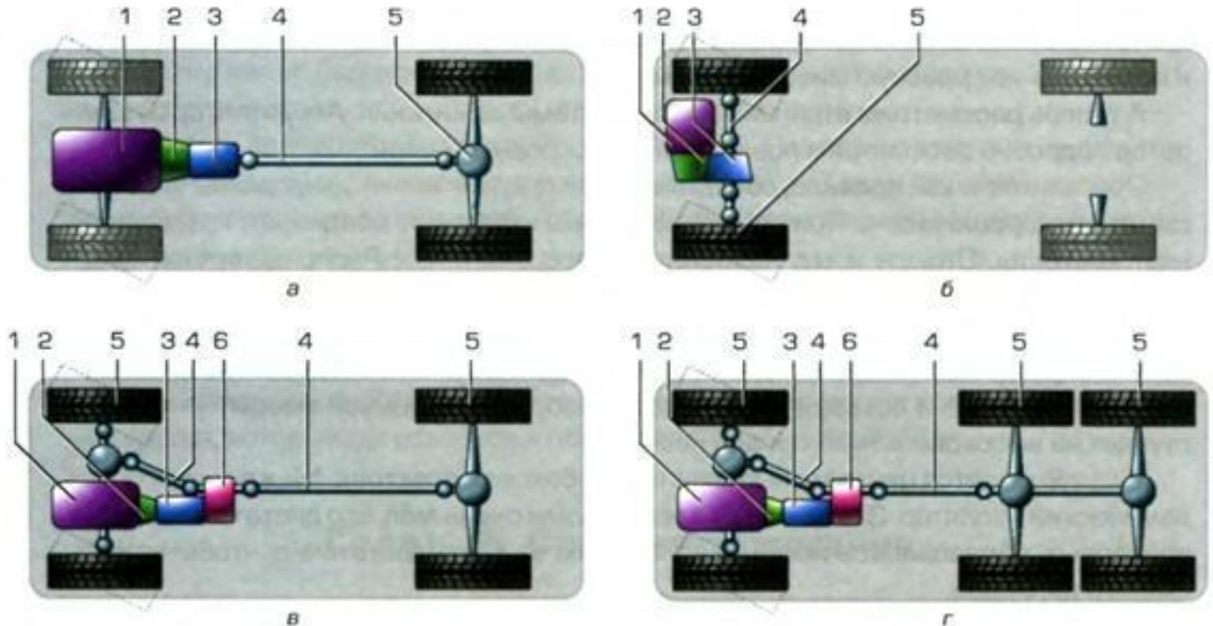
**Рис. 26. Схемы трансмиссий автомобилей:** а – заднеприводный автомобиль; б – переднеприводный автомобиль, в – полноприводный автомобиль колесной формулы 4x4; г – полноприводный автомобиль колесной формулы 6x6; 1 – двигатель; 2 – сцепление; 3 – коробка передач; 4 – карданная передача; 5 – ведущий мост; 6 – раздаточная коробка.
