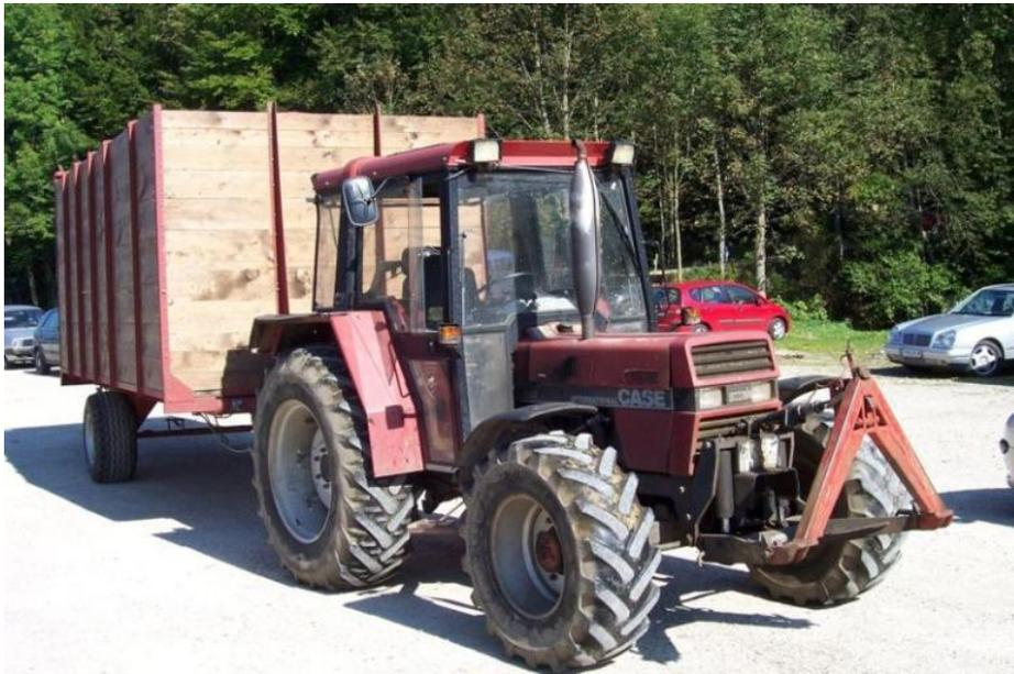
Рис. Фронтальная навесная система трактора CASE 933. Хорошо видны нижние тяги и центральная тяга. Красный треугольник, закрепленный на тягах — автосцепка
