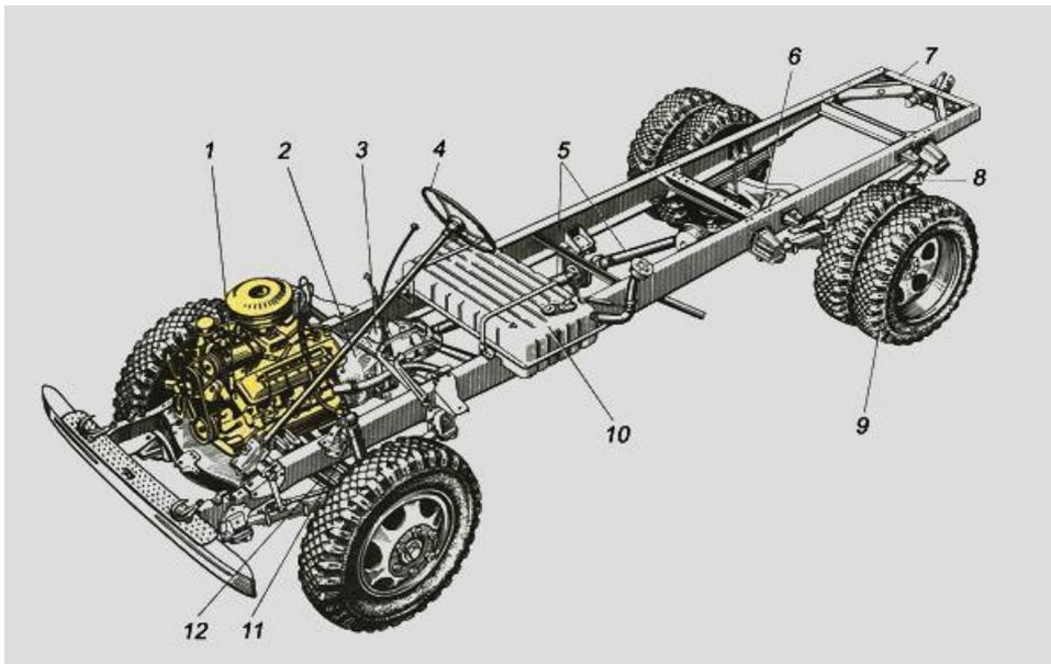
Рис. Двигатель и шасси грузового автомобиля.
