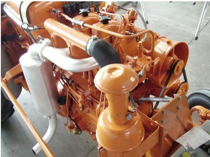
Рис. Двигатель воздушного охлаждения лёгкого трактора
