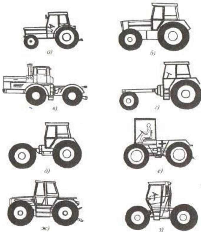
**Рис. Типы компоновок колесных сельскохозяйственных тракторов**
