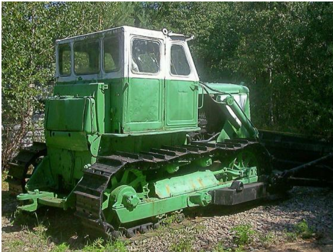
Рис. Жесткое прицепное устройство промышленного трактора Т-100
