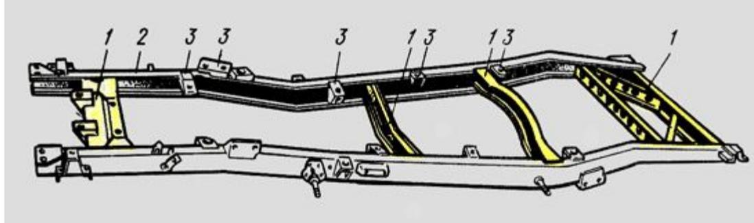
Рис. Лонжеронная рама грузового автомобиля
