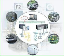
**Автоматизированная линия переработки – переналаживаемая система, состоящая из нескольких производственных модулей или ячеек, объединённых единой транспортно-складской системой и системой автоматического управления технологическим процессом (АСУТП). Оборудование автоматизированной линии расположено в принятой последовательности технологических операций.**
