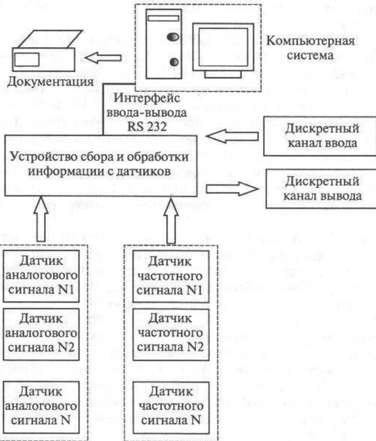
Структурная блок-схема удалённой компьютерной системы измерения, регистрации и обработки сигналов на базе однокристального микроконтроллера
