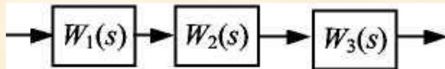
Рис. 9.3 Структурная схема системы с тремя звеньями
