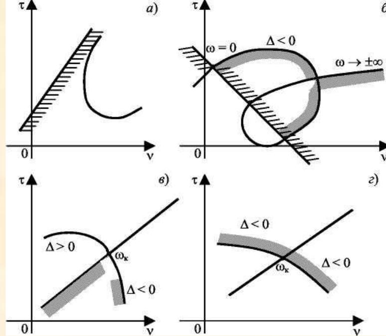
После нанесения штриховки определяют область, претендующую на область устойчивости, т.е. область, внутрь которой направлена штриховка. Пересечение границы Д-разбиения из заштрихованной зоны в незаштрихованную соответствует переходу двух комплексно-сопряженных корней из левой полуплоскости корней в правую, и наоборот. Пересечение особой прямой с одной штриховкой соответствует переходу одного корня.
