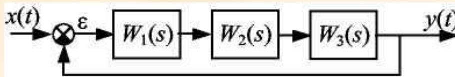
Рис. 9.1 Структурная схема системы автоматического регулирования
