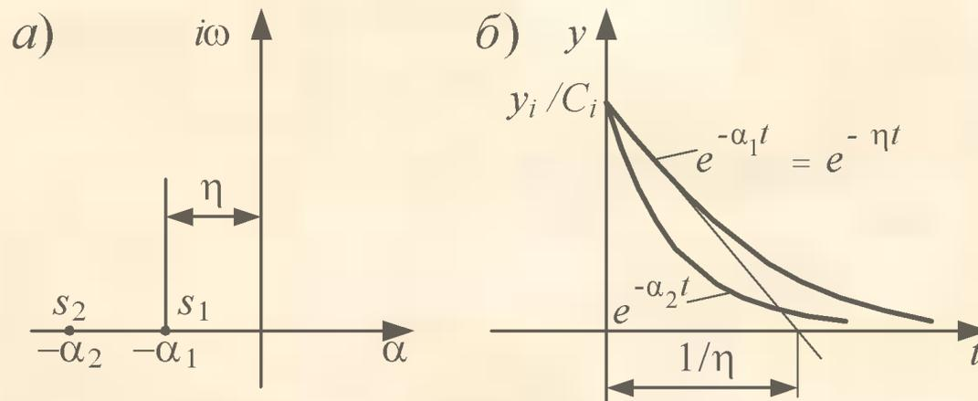
Рис. 8.3 определение качества монотонных переходных процессов по степени устойчивости: а - расположение корней характеристического уравнения; б - составляющие переходного процесса
