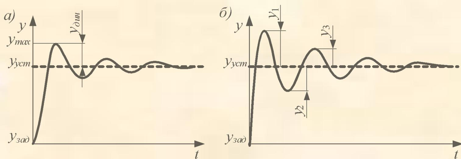
Рис. 8.2. Ошибки регулирования: а) перерегулирование; б) степень затухания
