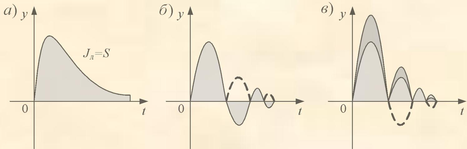
Рис. 8.5 Интегральные оценки качества регулирования: а - линейная; б - модульная; в - квадратичная
