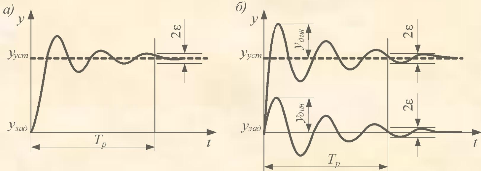
Рис. 8.1. Ошибки регулирования: а) статическая; б) динамическая
