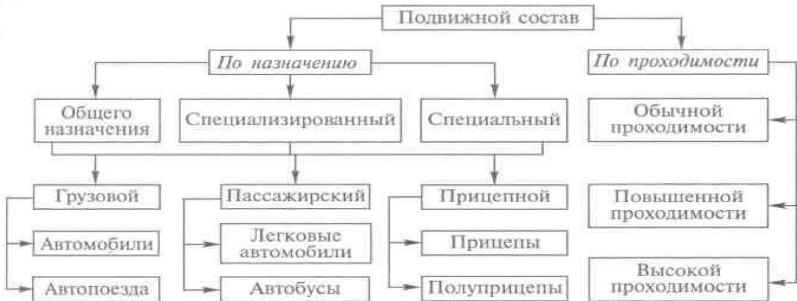
Рис. 1.1. Классификация типов подвижного состава автомобильного транспорта по назначению и проходимости
