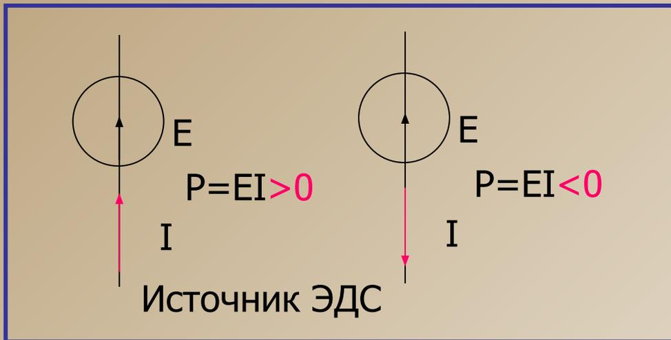
Если мощность источника тока или источника напряжения **положительна**, то он работает как **генератор**, т.е. отдает энергию, если отрицательна, то источник работает как **потребитель**.
