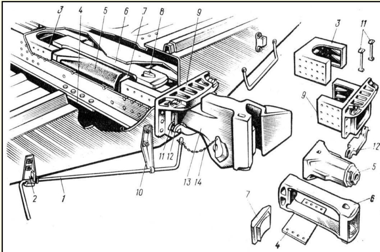
12 – центрирующая балочка; 13 – корпус автосцепки; 14 – цепочка.
