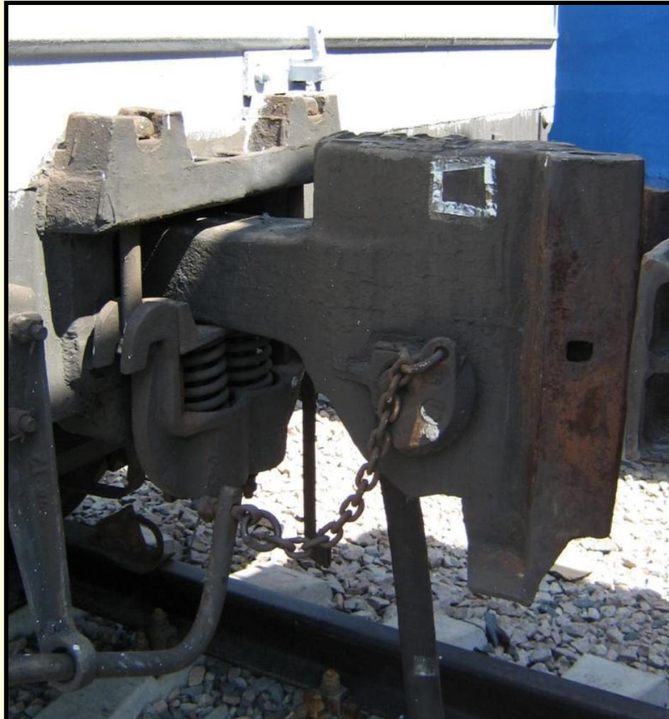
Для 8-ми осных вагонов и вагонов с длинной базой применены возвращающие устройства для снижения изгибающих сил (при проходе горба сортировочной горки)
