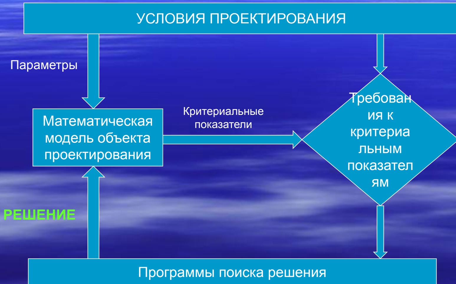
Программы расчета технических параметров основаны на расчетных методах, реализуют вычислительный алгоритм, который по входным параметрам и требованиям к объекту проектирования выдает числовые значения искомых параметров. Обычно такой алгоритм отражает решение системы уравнений или явную аналитическую (или эмпирическую) зависимость, обеспечивающую расчет искомых параметров при заданных входных условиях.
