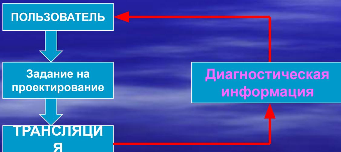
Содержанием задания является описание объекта проектирования на формальных языках, ориентированных на данный класс объектов. Содержанием цикла - формальная отладка задания, т. е. проверка, диагностирование и исправление ошибок описания.
