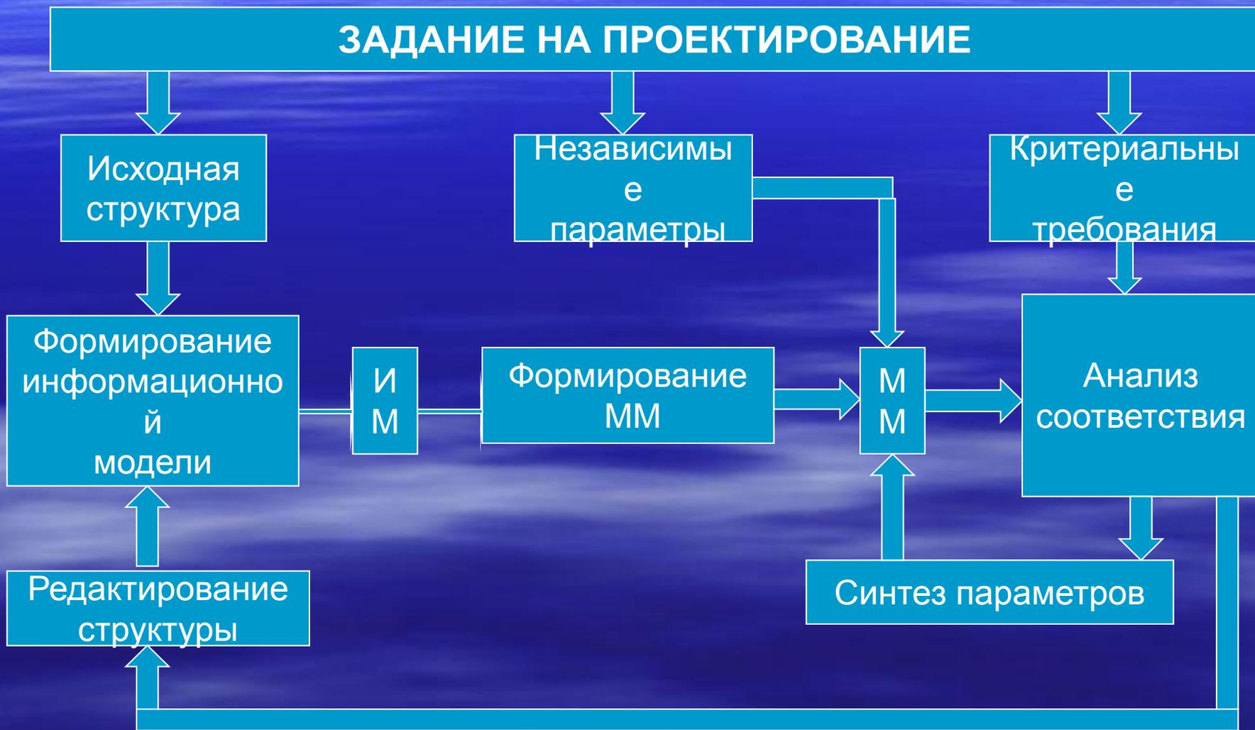
Формирование структуры при АП осуществляется в базисе проектирования, представляющем собой библиотеку описаний моделей элементов (базовых элементов) будущей структуры, допустимых к использованию.
