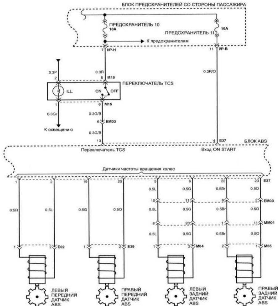
**Электрическая схема антиблокировочной тормозной системы**
