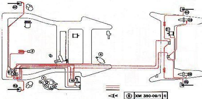
Схема ABS. электрическая и на машине
