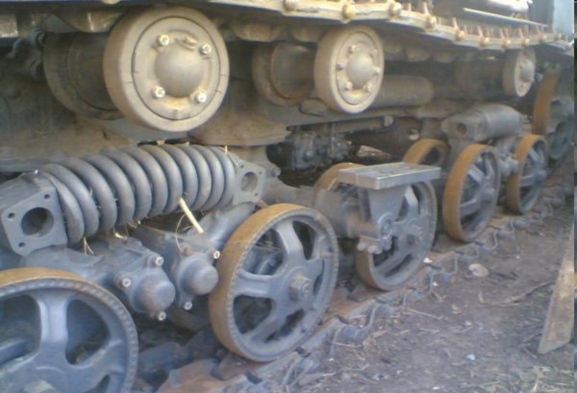
Ходовая часть и подвеска ХТЗ-181
