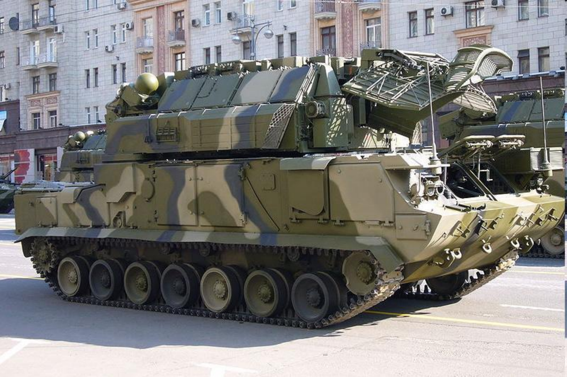
ЗРК ТОР-М1 на шасси ГМ-5955
