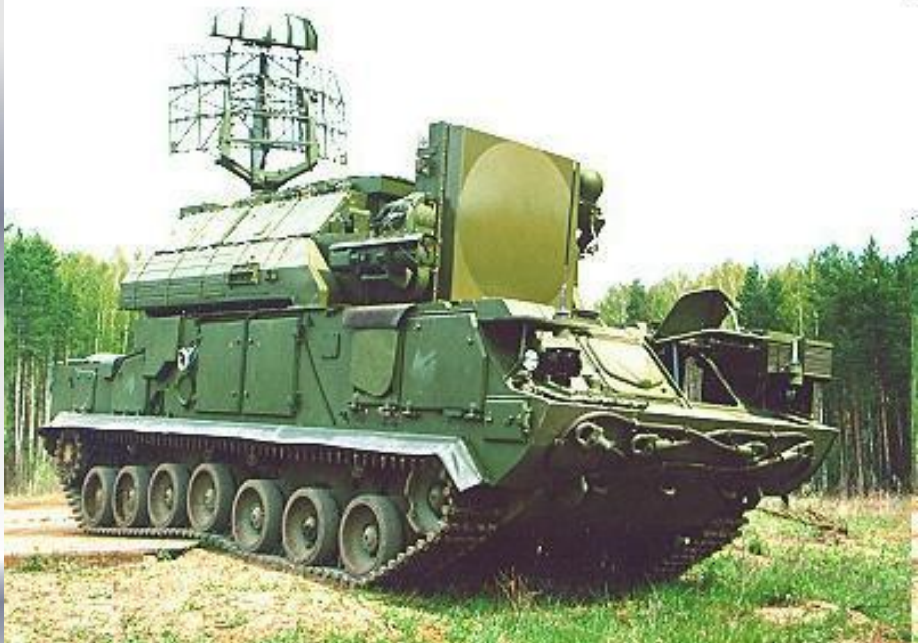
ЗРК ТОР-М1 на шасси ГМ-5955
