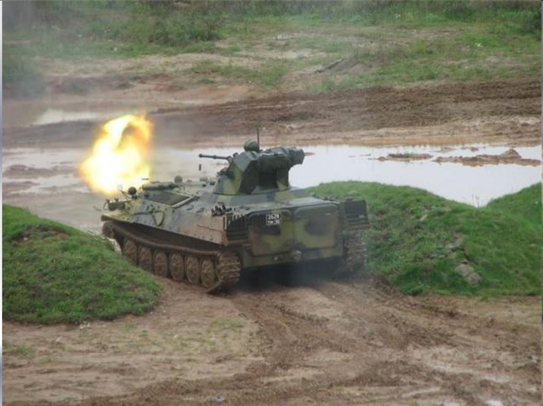
30мм 2А42 на шасси МТ-ЛБ-1
