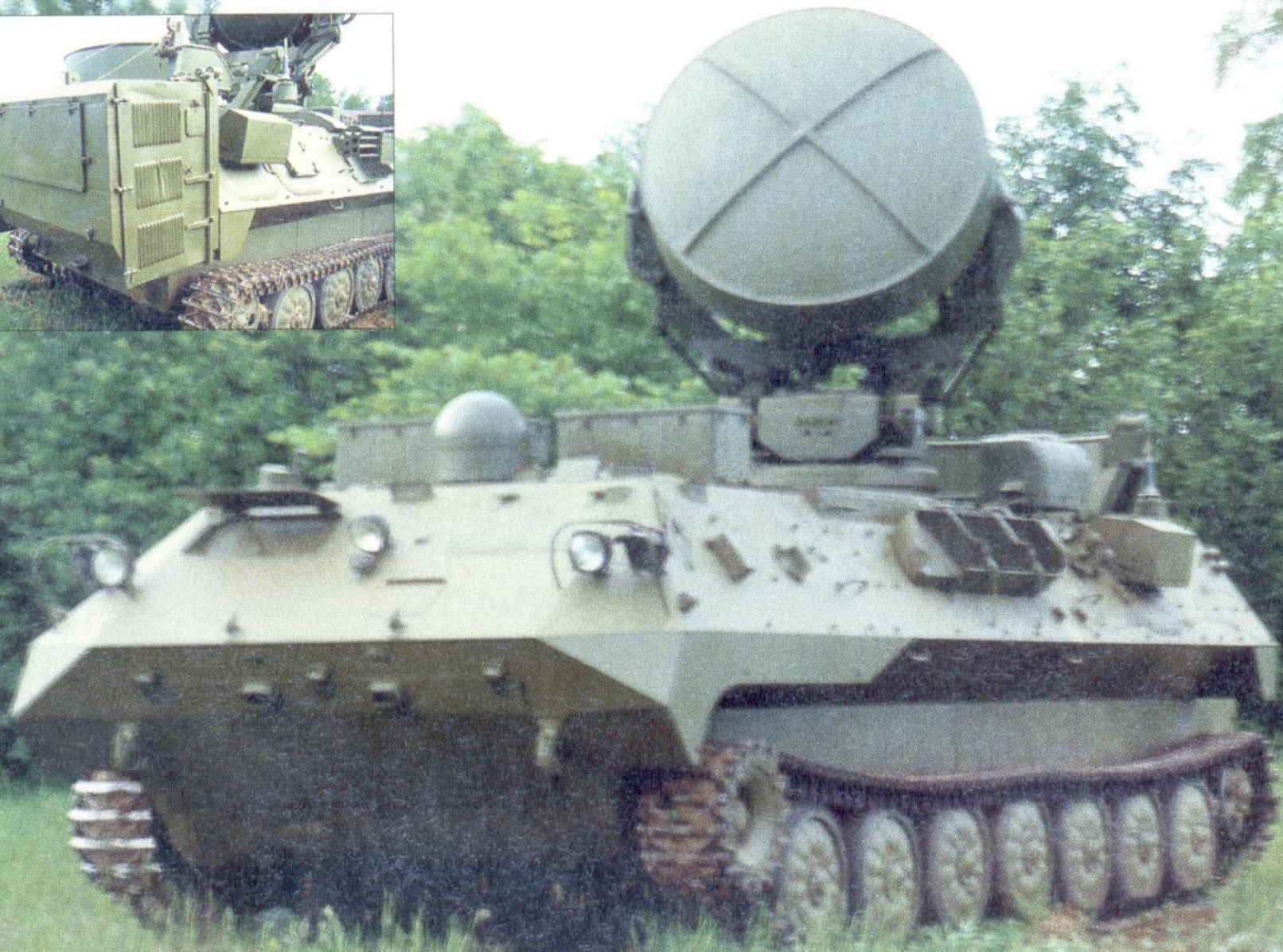
9С80 «Овод» на шасси МТ-ЛБу
