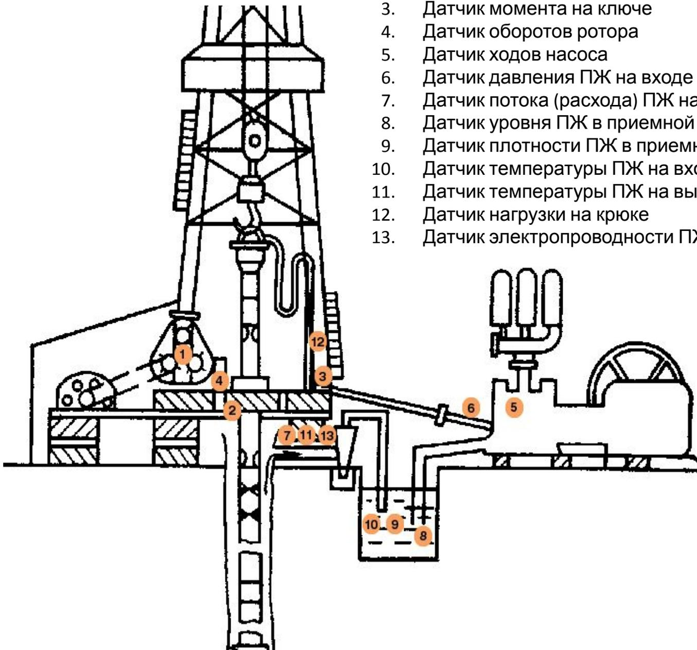
Подача инструмента - его вертикальное перемещение на поверхности, которое осуществляется опусканием ведущей трубы в ротор на некоторую величину в результате ослабления (оттормаживания) тормоза лебедки.
