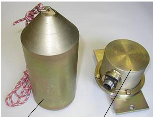
Гиря — Тензометрический датчик
