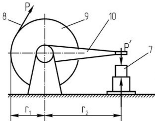
7 - магнитоупругий датчик; 8 - неподвижный конец каната талевой системы; 9 - барабан; 10 - рычаг; P – усилие в неподвижном конце каната; P' - усилие сжатия на магнитоупругий датчик
