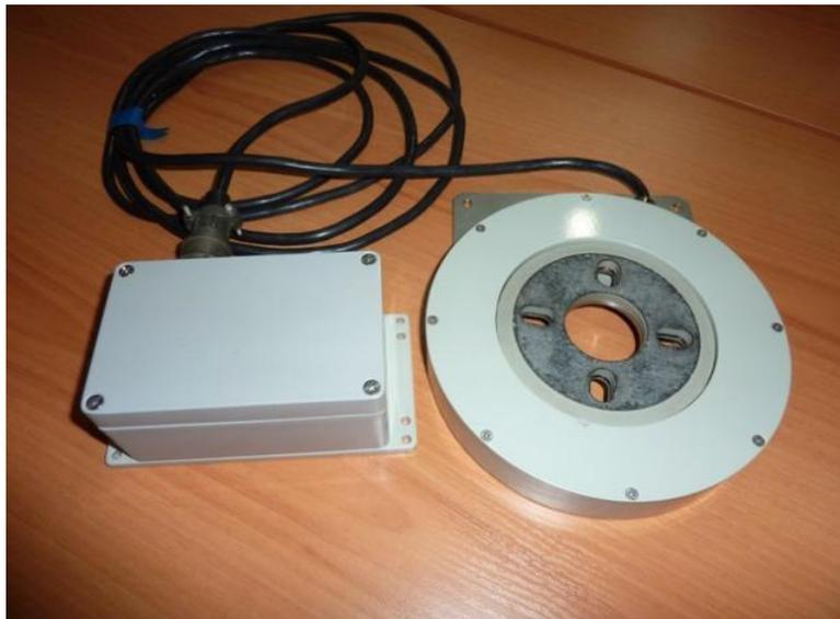
Датчик состоит из двух частей: первичного преобразователя (импульсного датчика) и микропроцессорного преобразователя сигнала
