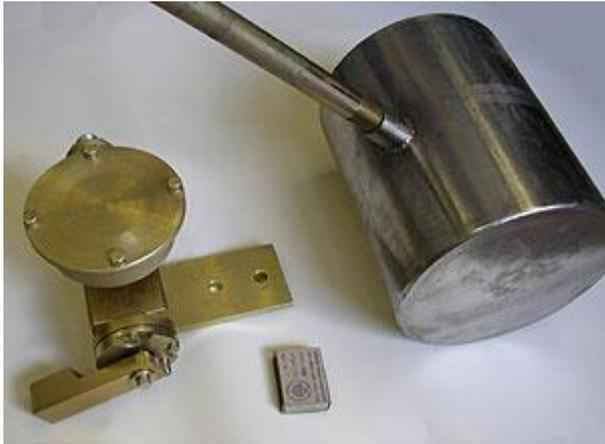
Уровень в емкости измеряется по углу отклонения штока с поплавком. Возможна перенастройка диапазонов измерений в широких пределах.
