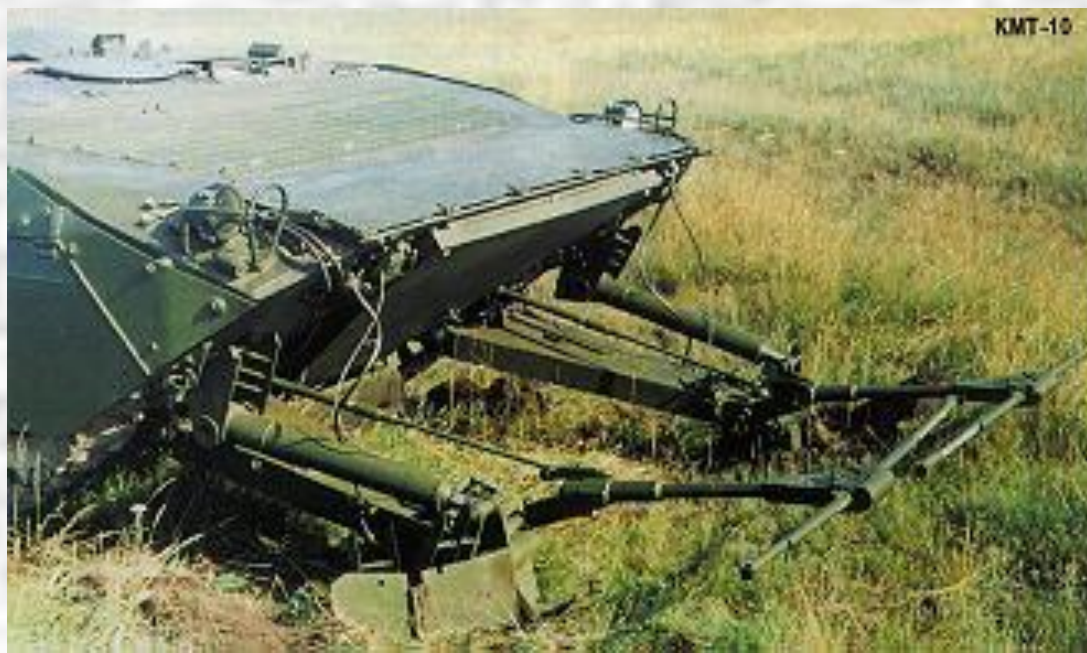
Колесный минный ножевой трал КМТ-10
