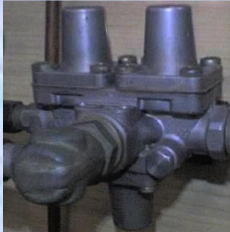
Клапан распределяет воздух, поступающий из компрессора, по трем контурам и при повреждении одного из них сохраняет давление в исправных контурах.
