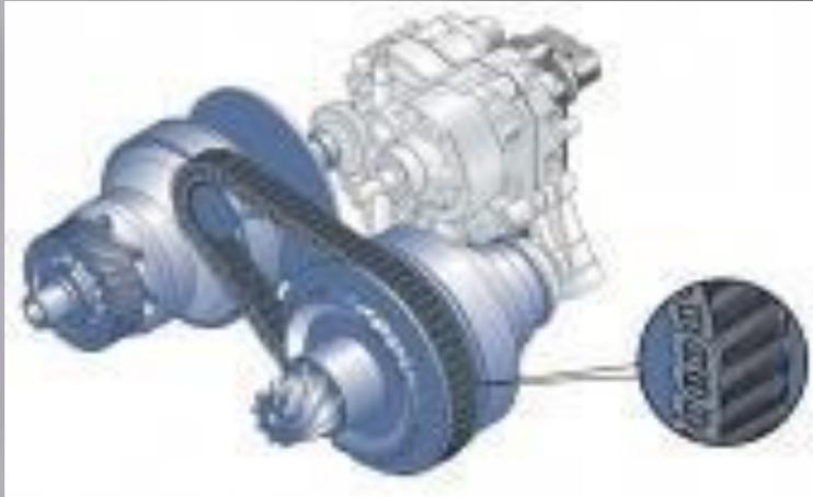
Фрикционные – это вариаторы, у которых передача крутящего момента осуществляется за счет сил трения на поверхности контакта. Делятся на: лобовые, конусные, шаровые, многодисковые, торовые, клиноременные.
