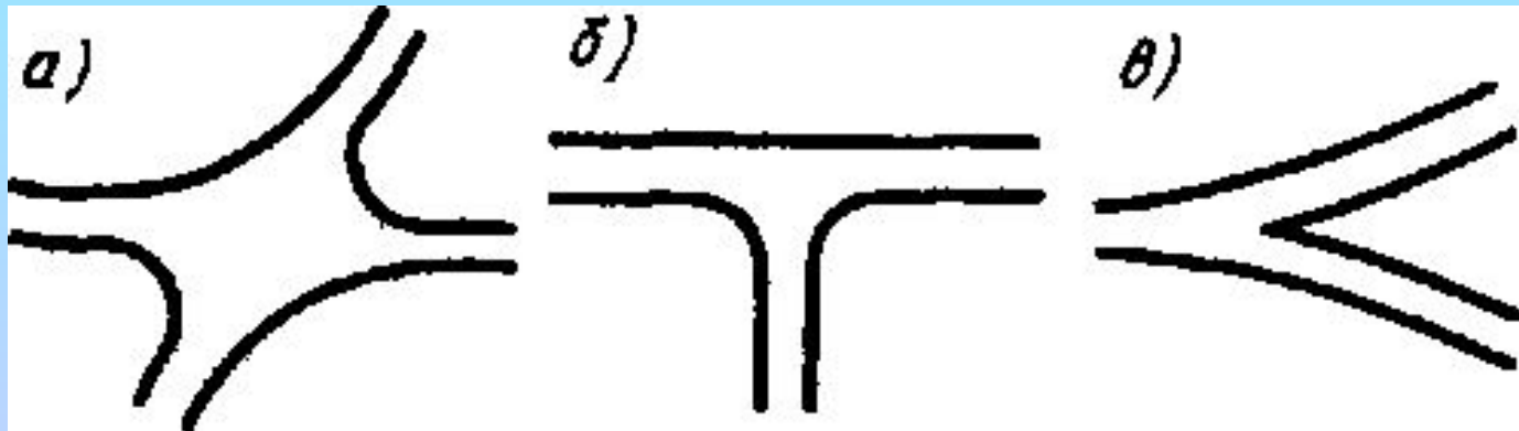
Рис. 10. Простые узлы автомобильных дорог в одном уровне:
