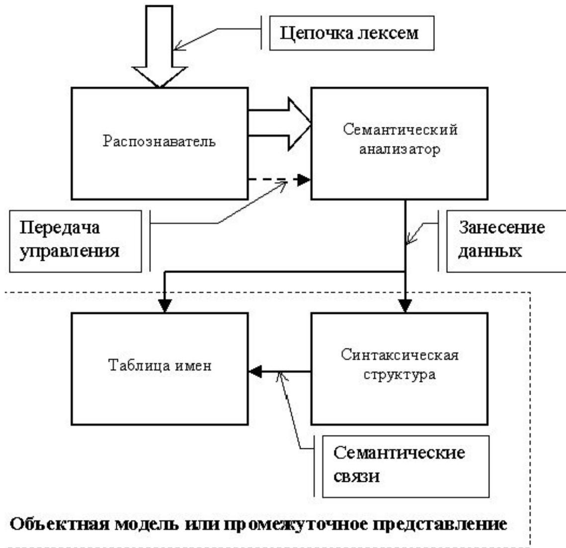
Рис. 1. Обобщенная схема синтаксического анализатора
