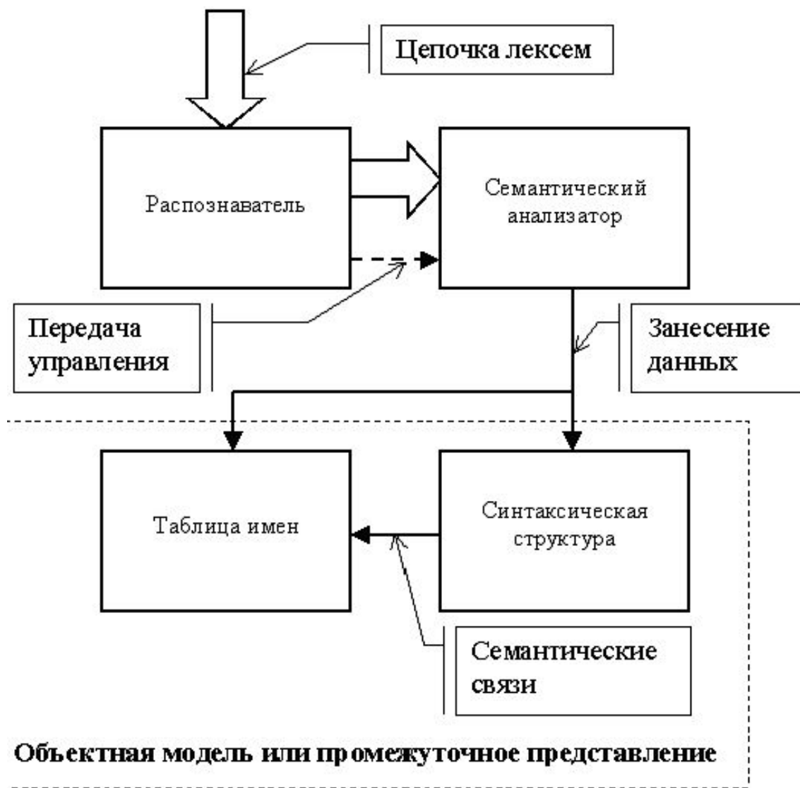
Рис. 1. Обобщенная схема синтаксического анализатора
