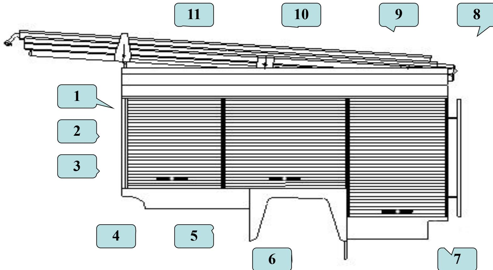
1 – боковая стойка с направляющей двери; 2 – шторная дверь отсека; 3 – рукоятка двери; 4, 7 – нижняя обшивка; 5 – подкрылок; 6 – брызговик; 8 – лестенка; 9 – верхняя обшивка; 10, 11 – опоры трёхколенной лестницы
