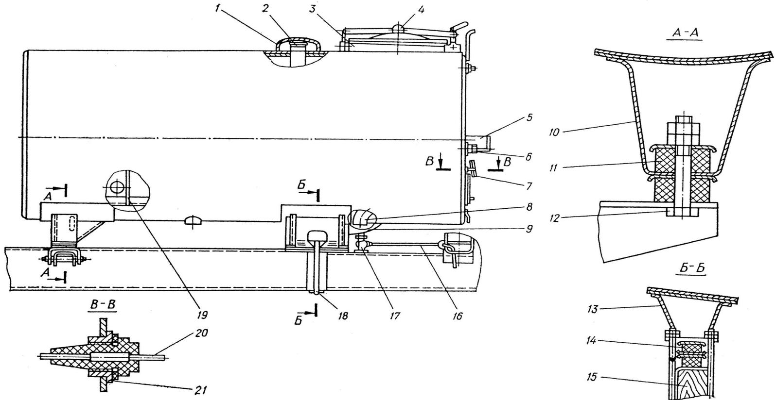
1, 4 – крышка; 2 – трубка контрольная; 3 – горловина; 5 – кронштейн; 6 – труба;
