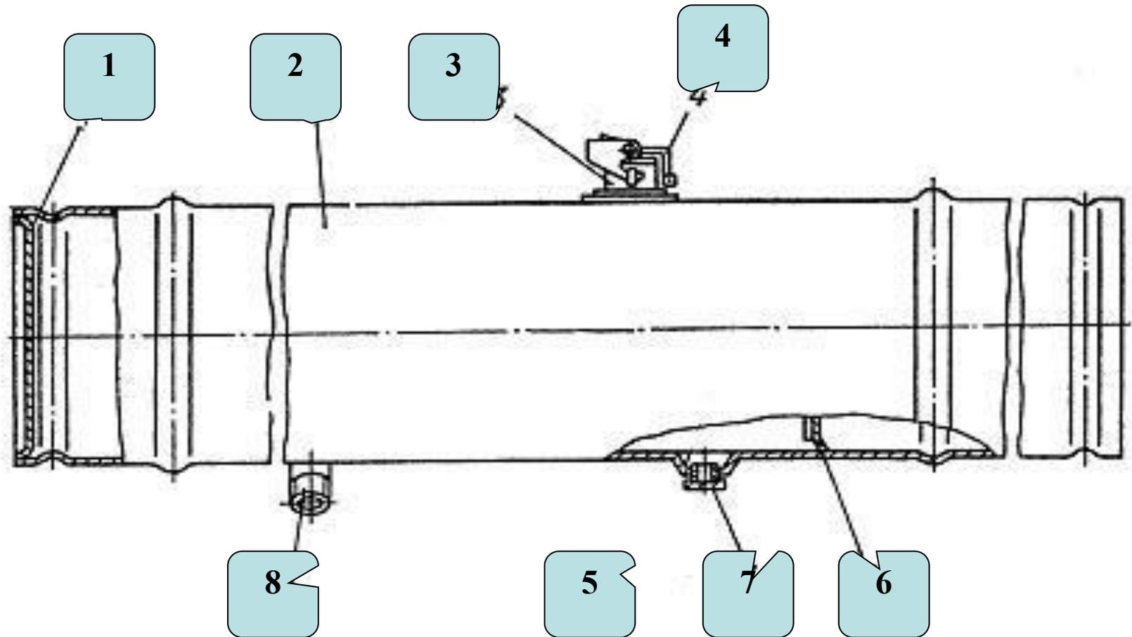
1 – днище; 2 – обечайка; 3 – горловина; 4 – крышка; 5 – отстойник; 6 – волнолом; 7 – заглушка; 8 – штуцер
