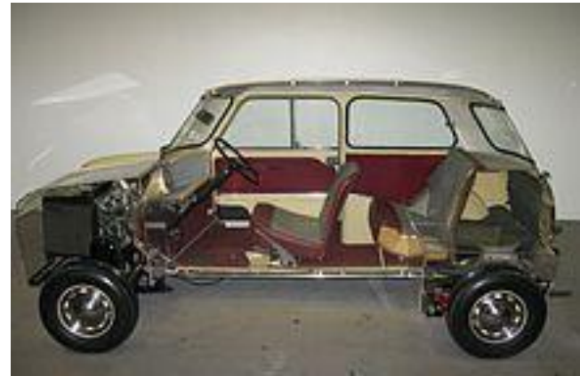
Второе место: Mini . Сечение показывает компоновку, предоставляющую пассажирам максимум места
