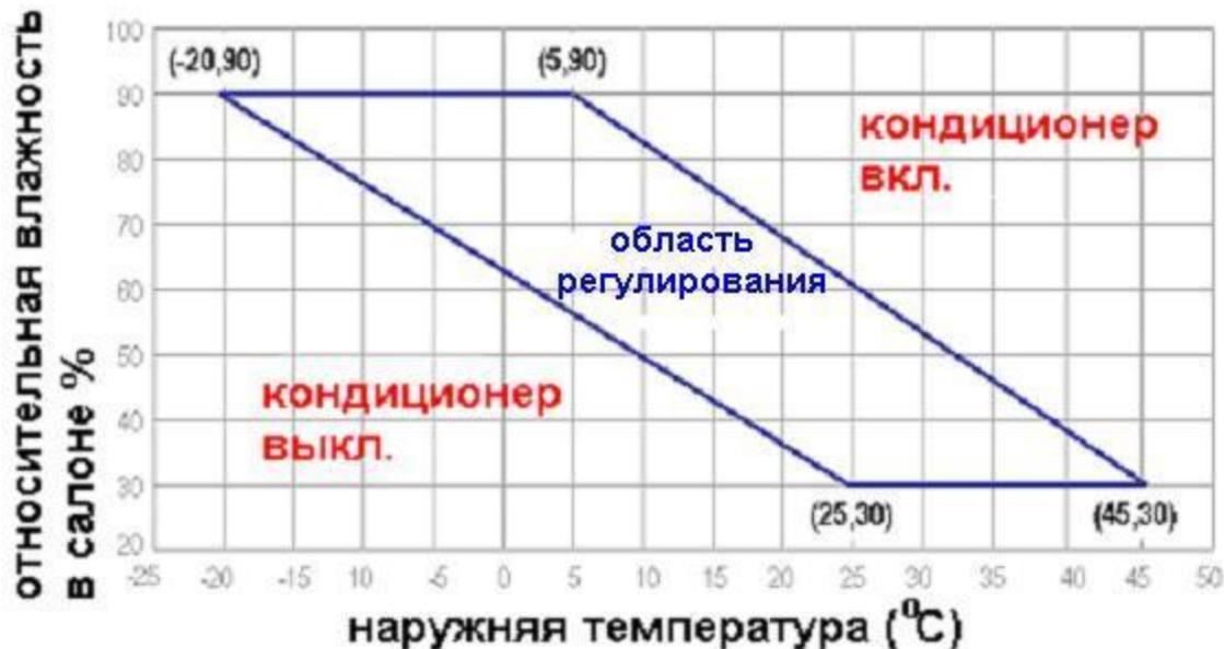
Если влажность внутри автомобиля превышает определённую величину, блок FATC включит систему кондиционирования чтобы уменьшить влажность и предотвратить запотевание стекол.
