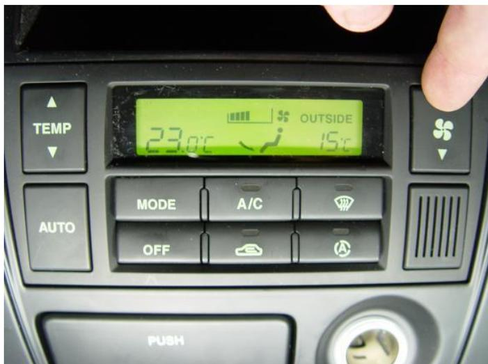
Блок FATC подаст “массу” на обмотки реле 2 и 3 в течение 30 секунд. Это позволяет механику проверить работоспособность цепей PTC heater element.
