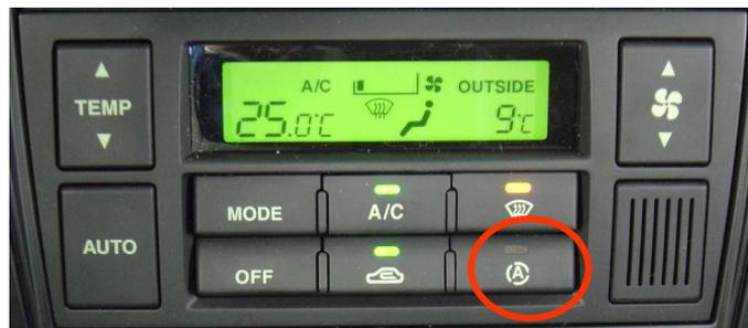
Система AQS является прекрасным решением ситуации. Процесс отсечки поступления наружного воздуха происходит мгновенно и автоматически. В системе предусмотрено и управление вручную. Помимо этого, система может быть установлена и на уже существующие автомобили.
