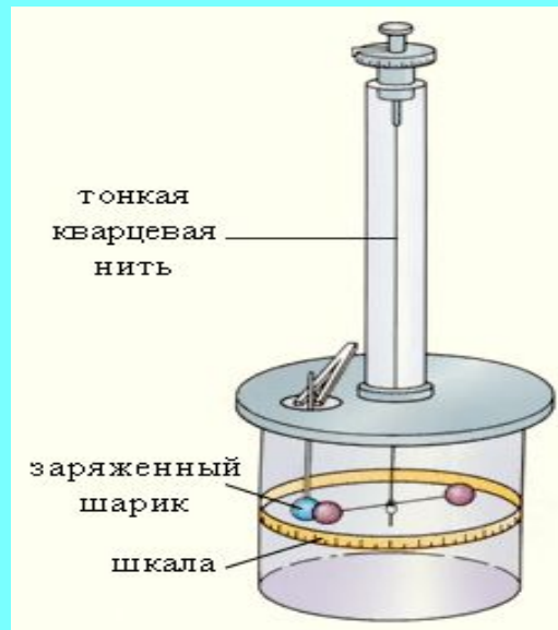
Рис.2.3. установка для изучения точечных зарядов
