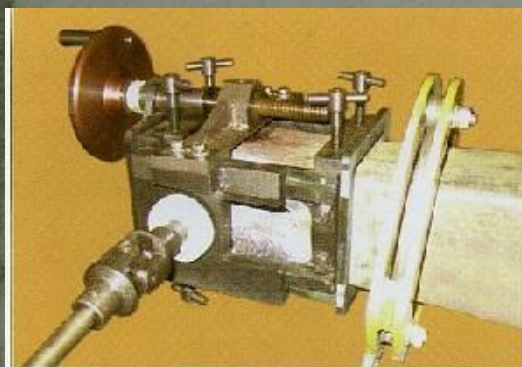
Приспособление для обработки перемычки хвостовика автосцепки (привод от Т98) Т413.00
