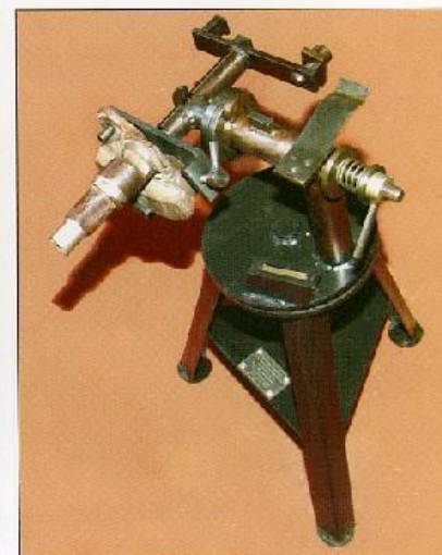
Приспособление для закрепления деталей автосцепки при их наплавке (замка, замкодержателя, подъемника замка, валика подъемника и маятниковой подвески) РП 34.00.000
