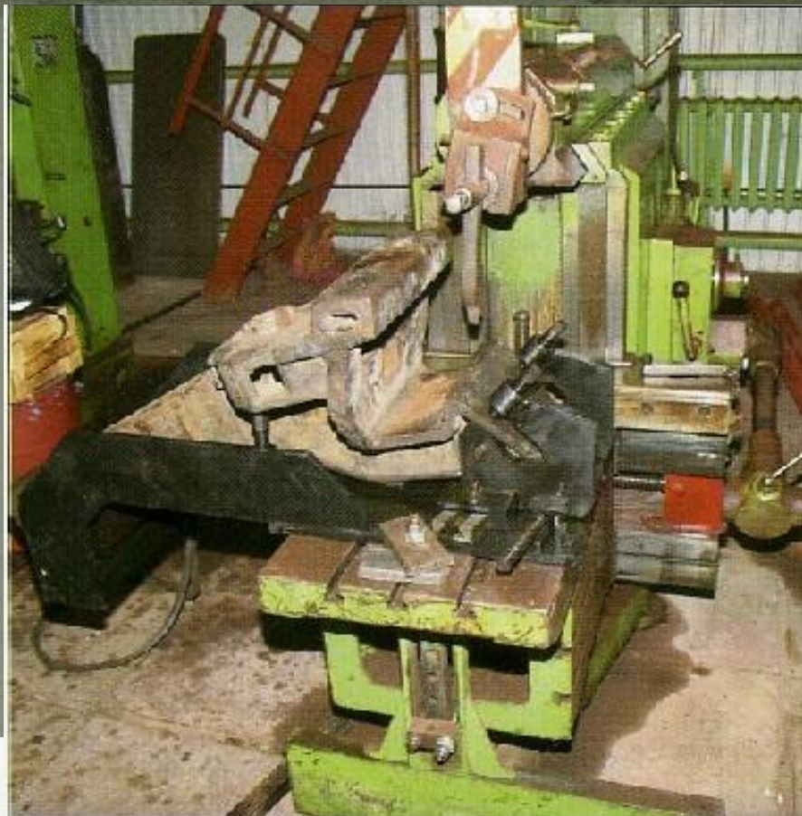
Приспособление к фрезерному и строгальному станкам для обработки корпуса автосцепки Т594.000
