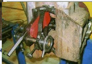
Приспособление фрезеровки шипа автосцепки (с приводом) Т98.00.00.000
