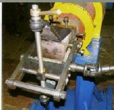
Приспособление обработки торца хвостовика автосцепки (с приводом) Т919.02.00.000
