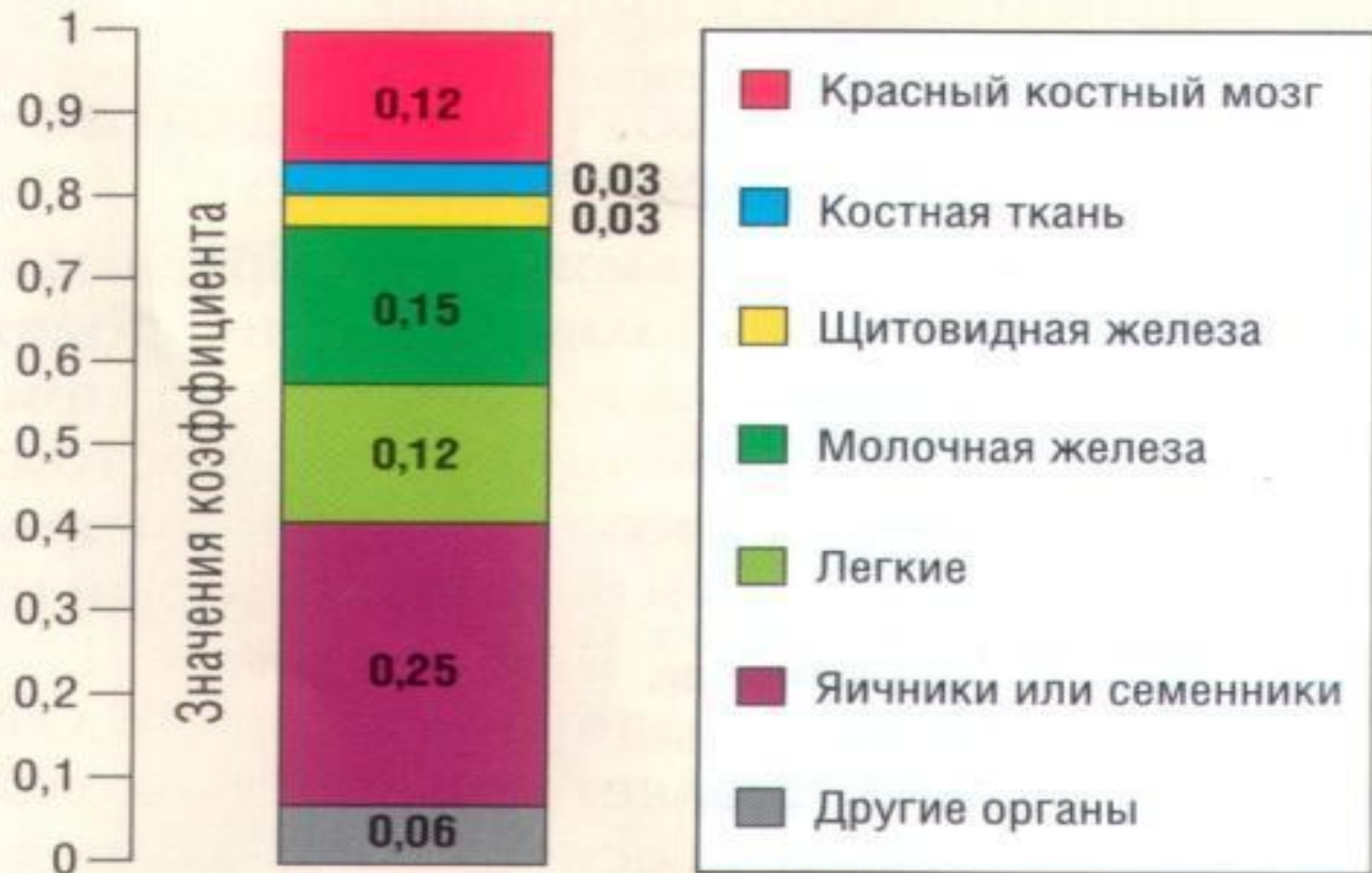
Рис. 1. Коэффициенты радиационного риска для разных органов человека при равномерном облучении (1,00 — организм в целом)
