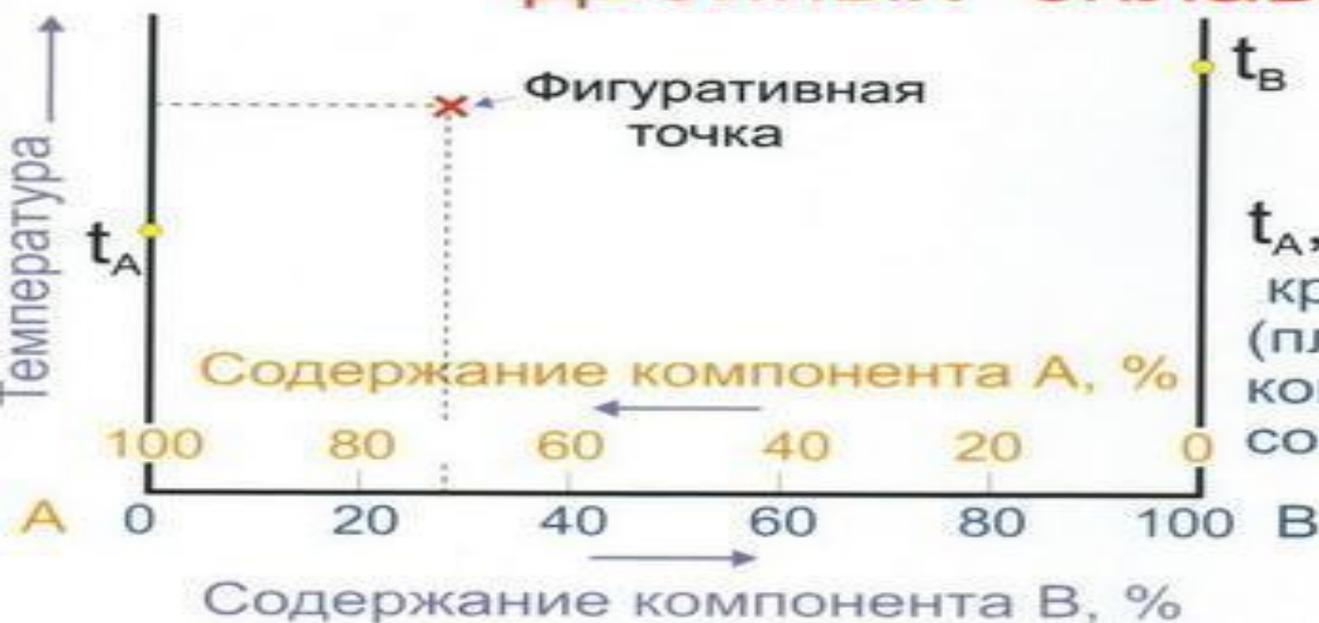
$t_A$ ,  $t_B$  - температуры кристаллизации (плавления) компонентов А и В, соответственно.
