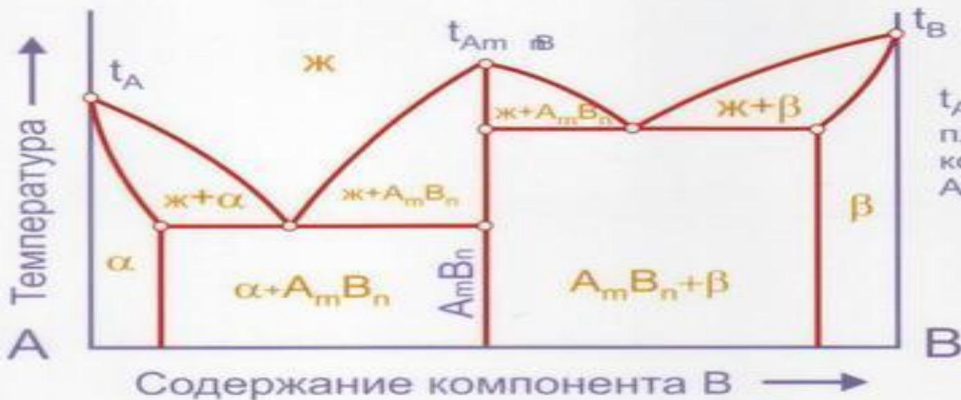
$t_{AmBn}$  - температура плавления химического соединения  $A_m B_n$
