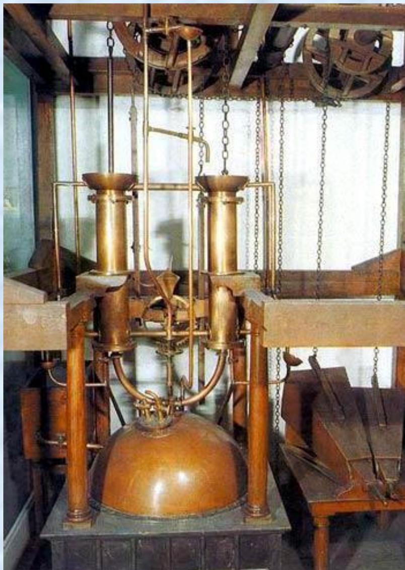
Макет двухцилиндровой паровой машины
