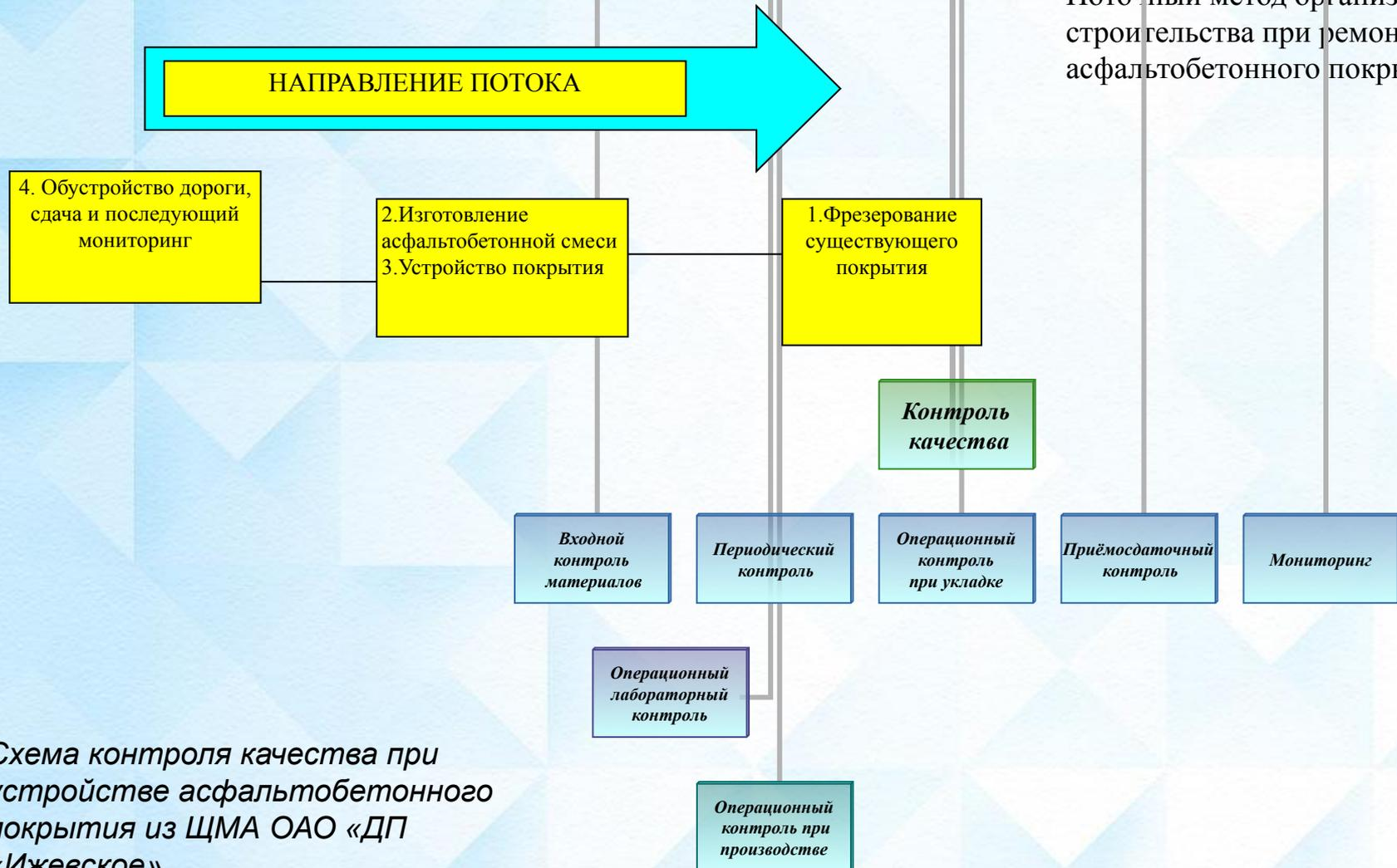
Схема контроля качества при устройстве асфальтобетонного покрытия из ЩМА ОАО «ДП «Ижевское»
