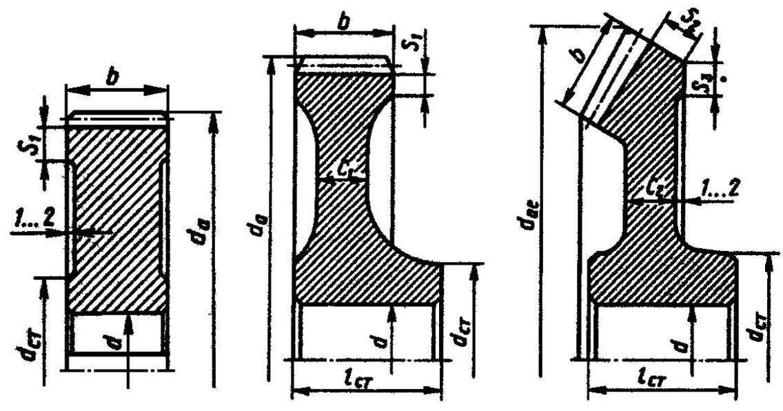
Конструктивные параметры зубчатых колес представлены на рис. 5.3. Толщина обода цилиндрических и конических зубчатых колес может быть выбрана по соотношению
