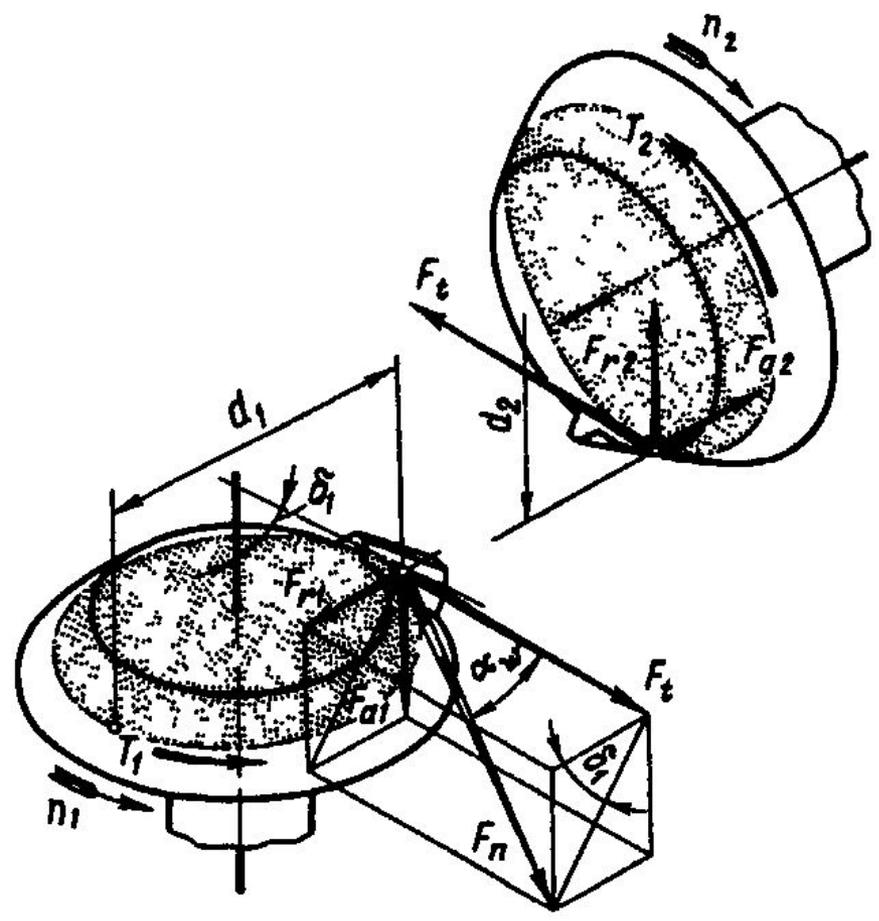
В конической зубчатой передаче как и в цилиндрической косозубой появляются осевые составляющие силы взаимодействия зубьев, но причиной их возникновения является наклонное расположение зубьев. Силы в конической зубчатой передаче обычно приводятся к плоскости срединного сечения зубчатого венца (рис. 5.7).
