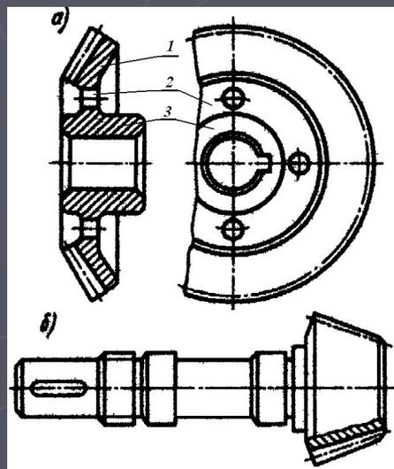
**диск** – часть зубчатого колеса, соединяющая обод со ступицей; в литых и сварных зубчатых колесах диск зачастую заменяется отдельными спицами
