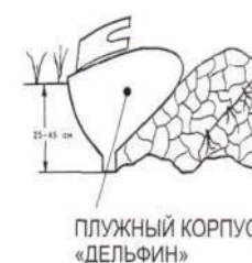
Схема вспашки почвы с оборотом пласта
