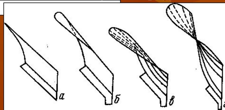
*a* - цилиндрический; *б* - культурный; *в* - полувинтовой; *г* - винтовой
