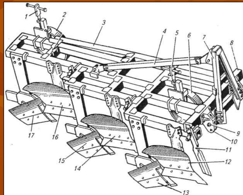
**1, 5** - винтовые механизмы; **2, 6** - опорные колеса; **3** - рама; **4** - тяга; **7** - замок навески; **8** - поперечная балка; **9** - кронштейн; **10** - отверстия; **11** - черенковый нож; **12, 14, 16** - корпуса верхнего яруса; **13, 15, 17** - корпуса нижнего яруса.
