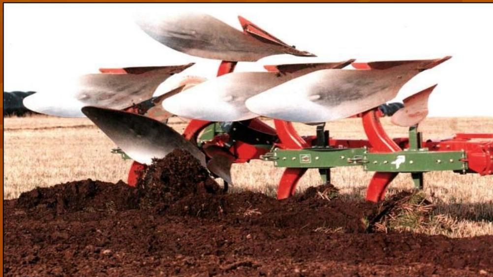
б) с гидроневматическими предохранителями
