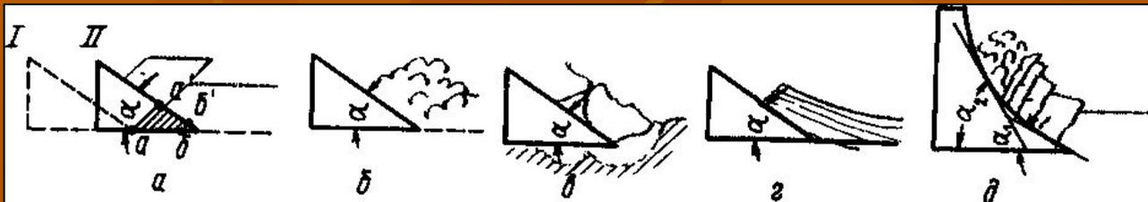
*a* – почва нормальной влажности; *б* – малосвязная почва; *в* – сухая и твёрдая почва; *г* – влажная и
