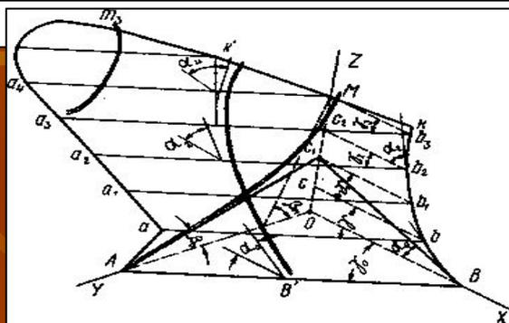
*ab* - линии пересечения горизонтальных плоскостей с поверхностью отвала; *В'К'* - линия пересечения продольно-вертикальной плоскости с поверхностью отвала; *AM* - линия пересечения поперечно-вертикальной плоскости с поверхностью отвала
