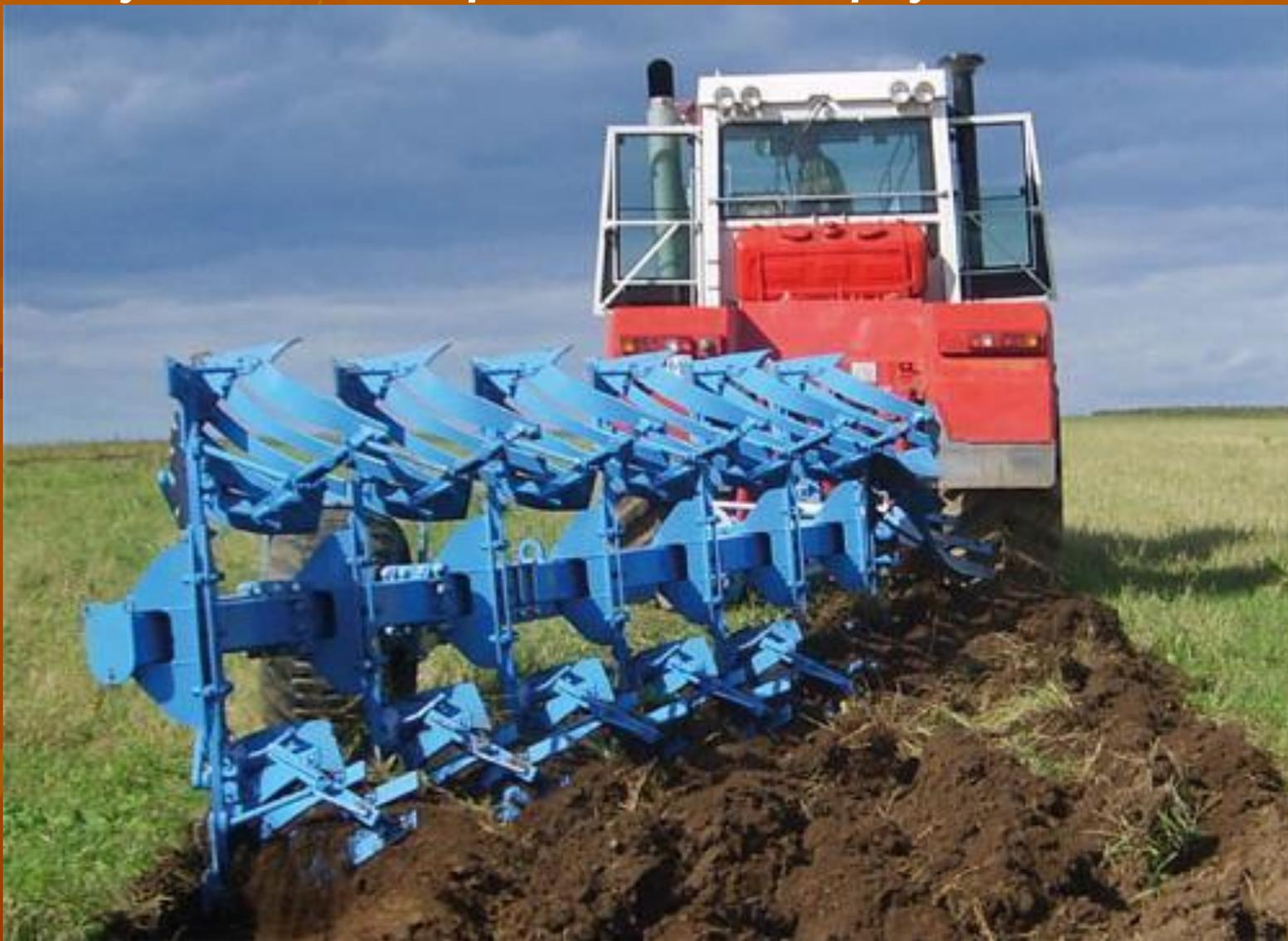
Ширина захвата плуга **245-287-329 см** (одного корпуса **33,5; 41 или 47 см**); глубина вспашки **до 32 см**; рабочая скорость **6-8 км/ч**; производительность **1,7-2,3 га/ч**; масса **2500 кг**; агрегатируется с тракторами **5 класса тяги**.
