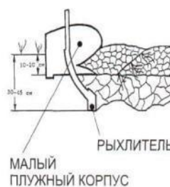
Схема комбинированной обработки почвы
