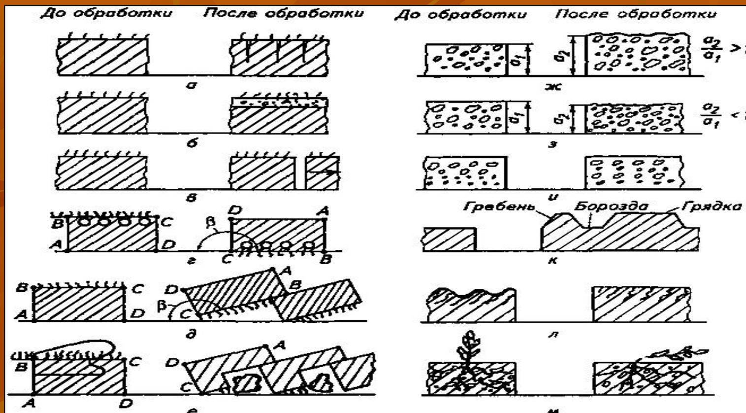
*a* — вертикальное резание; *б* — горизонтальное резание; *в* — отделение пласта; *г* — оборот пласта; *д* — взмёт пласта; *е* — культурная вспашка с предплужником; *ж* — рыхление; *з* — уплотнение; *и* — перемешивание; *к* — нарезка борозд, образование гряд и гребней; *л* — выравнивание; *м* — подрезание сорняков; **ABCD** — пласт;  $\beta$  — угол оборота пласта;  $a_1$  и  $a_2$  — толщина почвенных слоёв соответственно до обработки и после.
