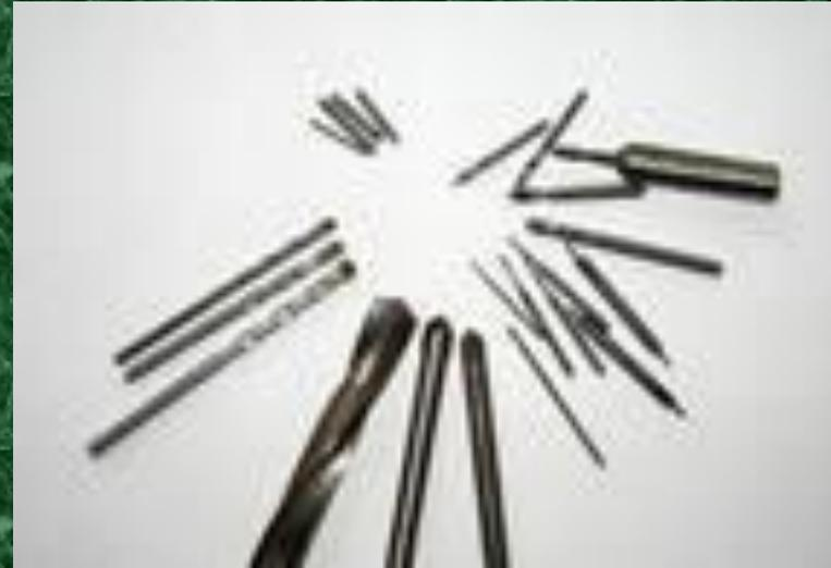
Быстрорежущие стали обозначаются буквой Р в начале марки и цифрой, указывающей среднее содержание вольфрама в стали. Далее следуют буквы и цифры, определяющие массовые доли других элементов.
