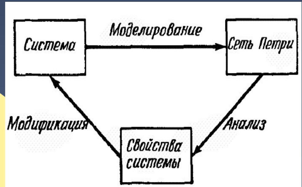
Процесс проектирования и определения характеристик проводится в терминах сетей Петри. Методы анализа применяются только для создания проекта сети Петри, свободного от ошибок. Задача заключается в преобразовании представления сети Петри в реальную рабочую систему.
