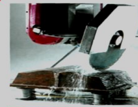
Резка и профилирование диском
