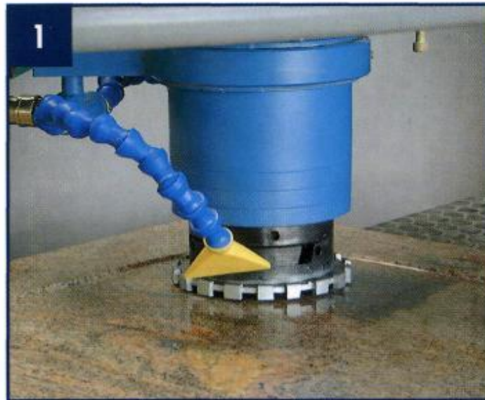
Операция торцевого фрезерования поверхности плиты
