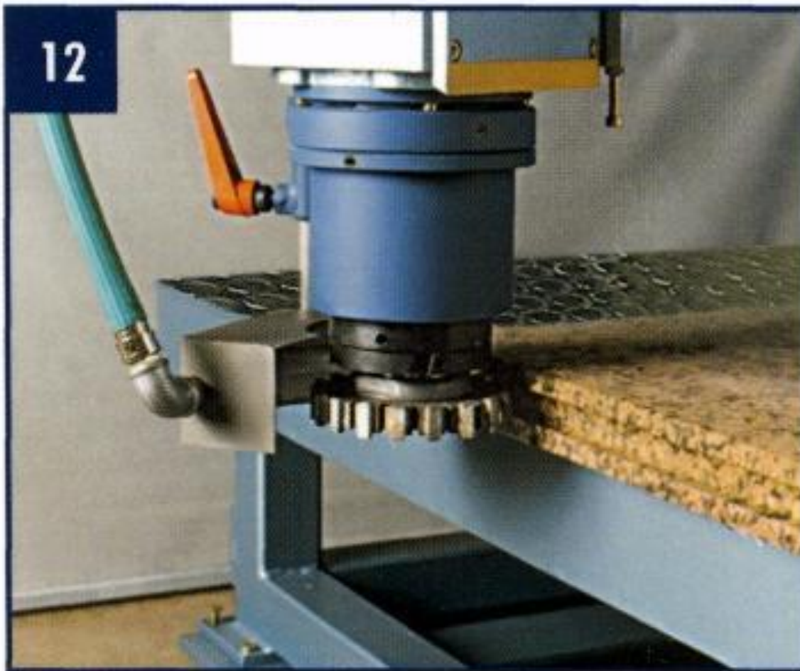
Операция прорезки паза цилиндрической фрезой
