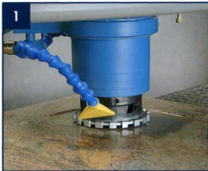
Операция торцевого фрезерования поверхности плиты
