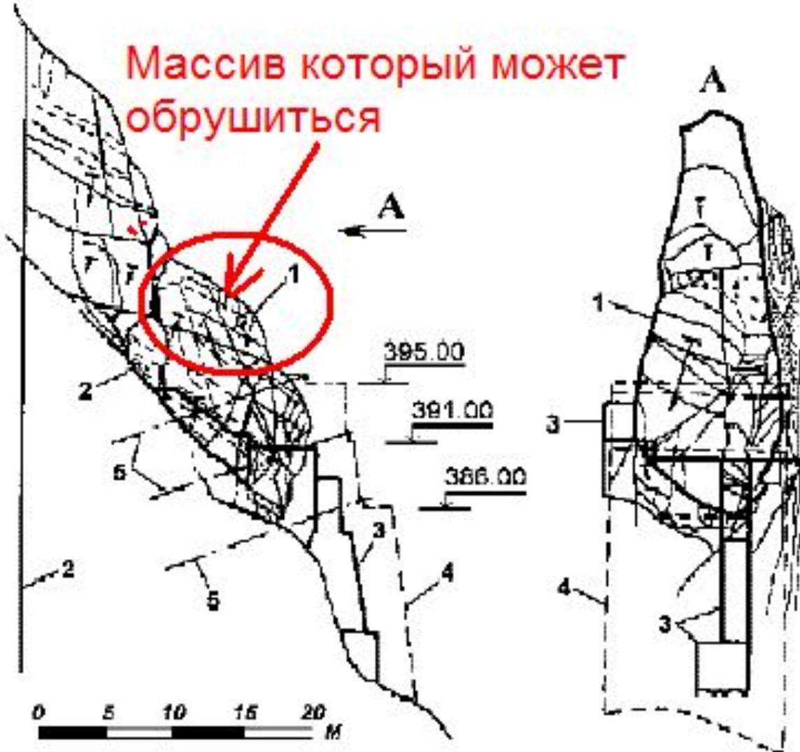
Рис. 2.9 Незакрепленный скальный массив, подвижка которого произошла в результате землетрясения 3 балла
