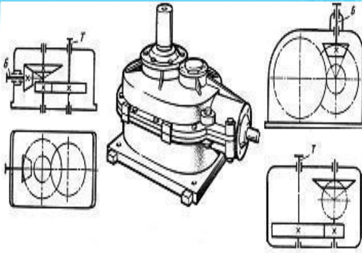
**Рисунок 6 - Коническо-цилиндрические редукторы**
