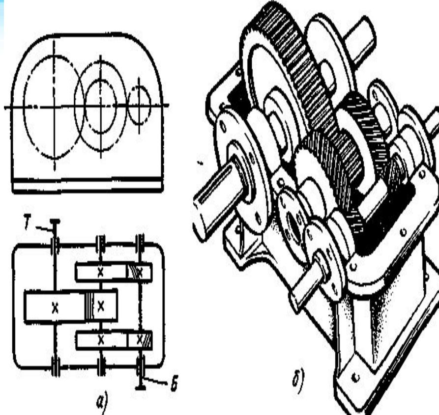
**Рисунок 4 а** - Двухступенчатый цилиндрический редуктор с раздвоенной ступенью
