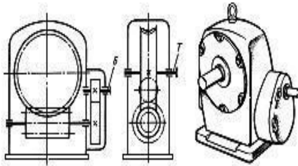
**Рисунок 8 - Червячно-цилиндрический двухступенчатый редуктор**
