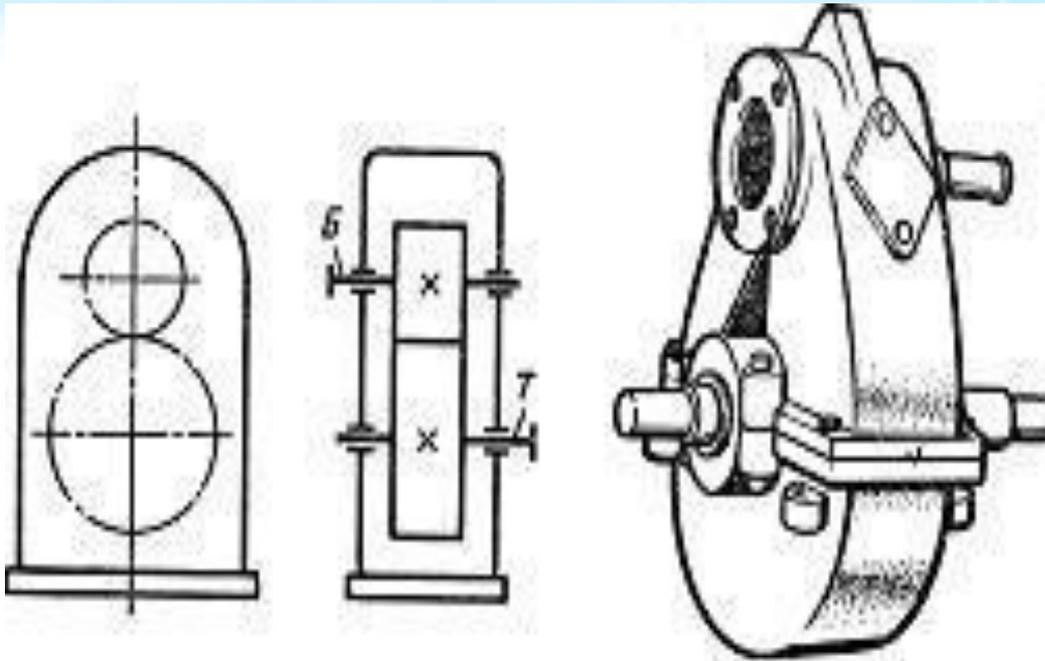
**Рисунок 2** - Одноступенчатый цилиндрический редуктор вертикальный
