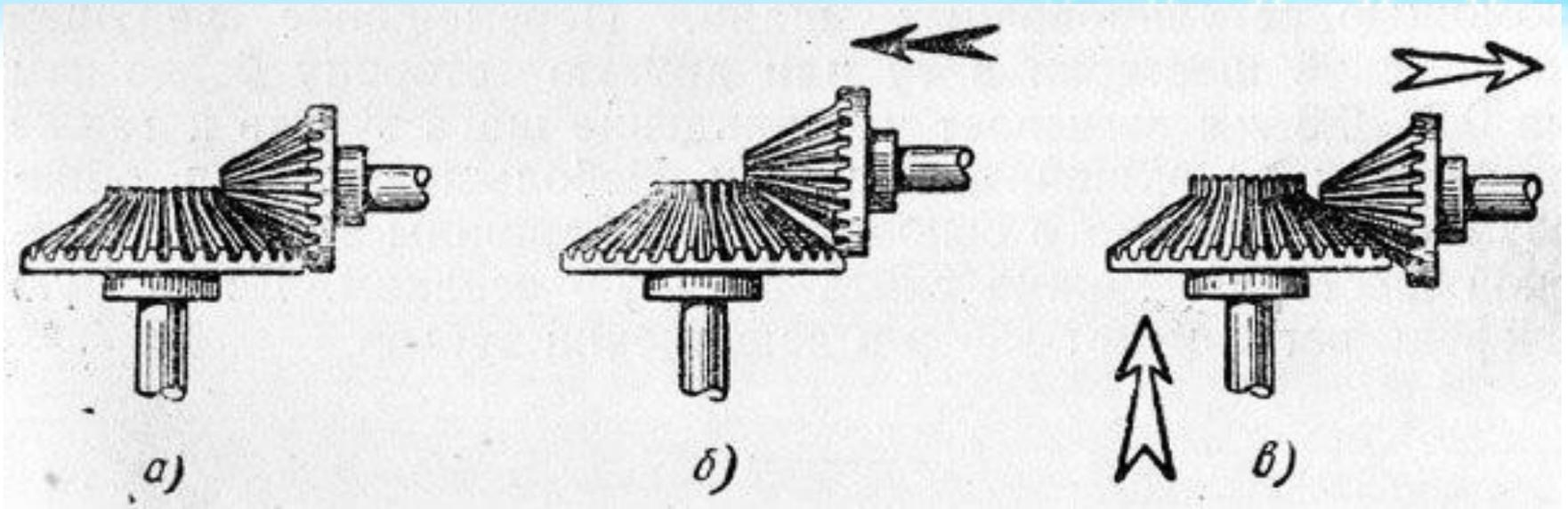
**Регулировка зацепления зубьев сильно изношенных конических шестерен**
