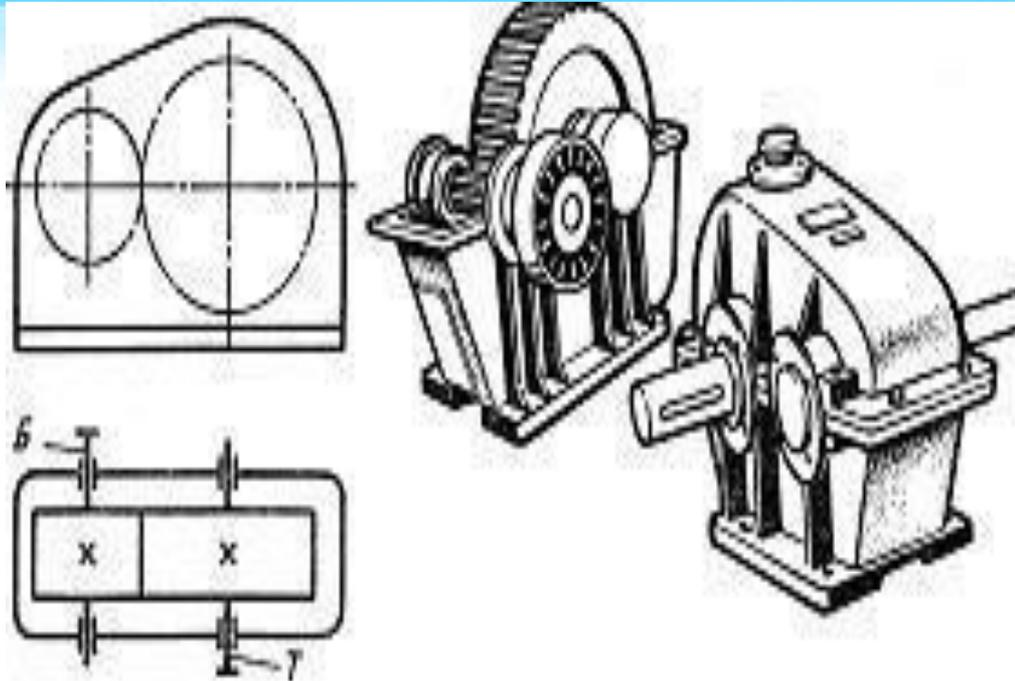
**Рисунок 1** - Одноступенчатые цилиндрические редукторы горизонтальные
