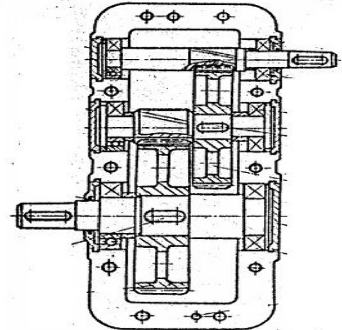
**Рисунок 3 б** - Двухступенчатый цилиндрический редуктор вертикальный
