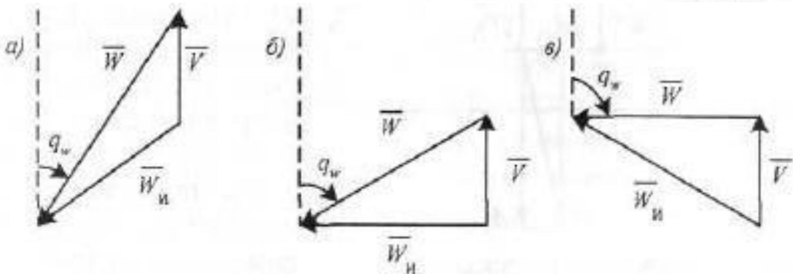
Рис. 2.5. Курсовой угол кажущегося ветра на движущемся судне
