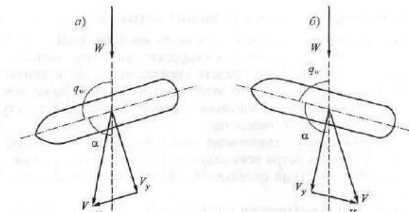
Рис. 2.9. Положение судна при свободном дрейфе в зависимости от знака смещения ЦП от ЦТ: а) ЦП смешен в нос от ЦТ; б) ЦП смешен в корму от ЦТ
