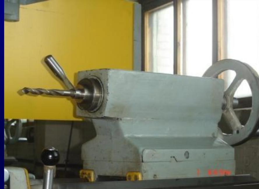
Предназначается для поддержания конца длинных заготовок в процессе обработки
