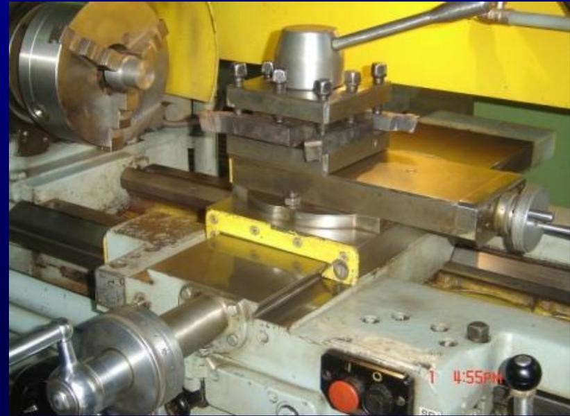
На поперечных салазках суппорта крепится резцедержатель, в котором помещаются четыре резца. Это устройство для закрепления резца, обеспечивающее движение подачи, то есть перемещения резца в различных
