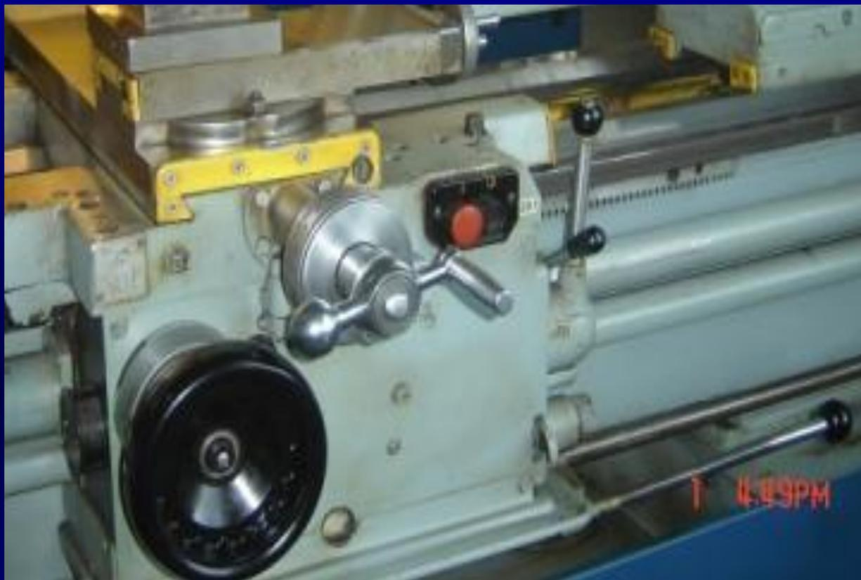
Служит для перемещения суппорта, как вручную так и механически. В нем находятся механизмы преобразующие вращательное движение ходового винта и ходового валика в поступательное
