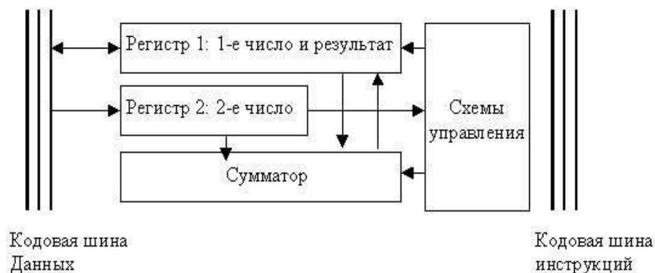
**Сумматор** - вычислительная схема, выполняющая процедуру сложения поступающих на ее вход двоичных кодов; сумматор имеет разрядность двойного машинного слова.
