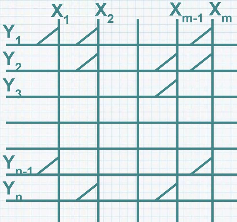
Каждая из горизонтальных шин служит для хранения одного числа, вертикальные шины – разрядные.
