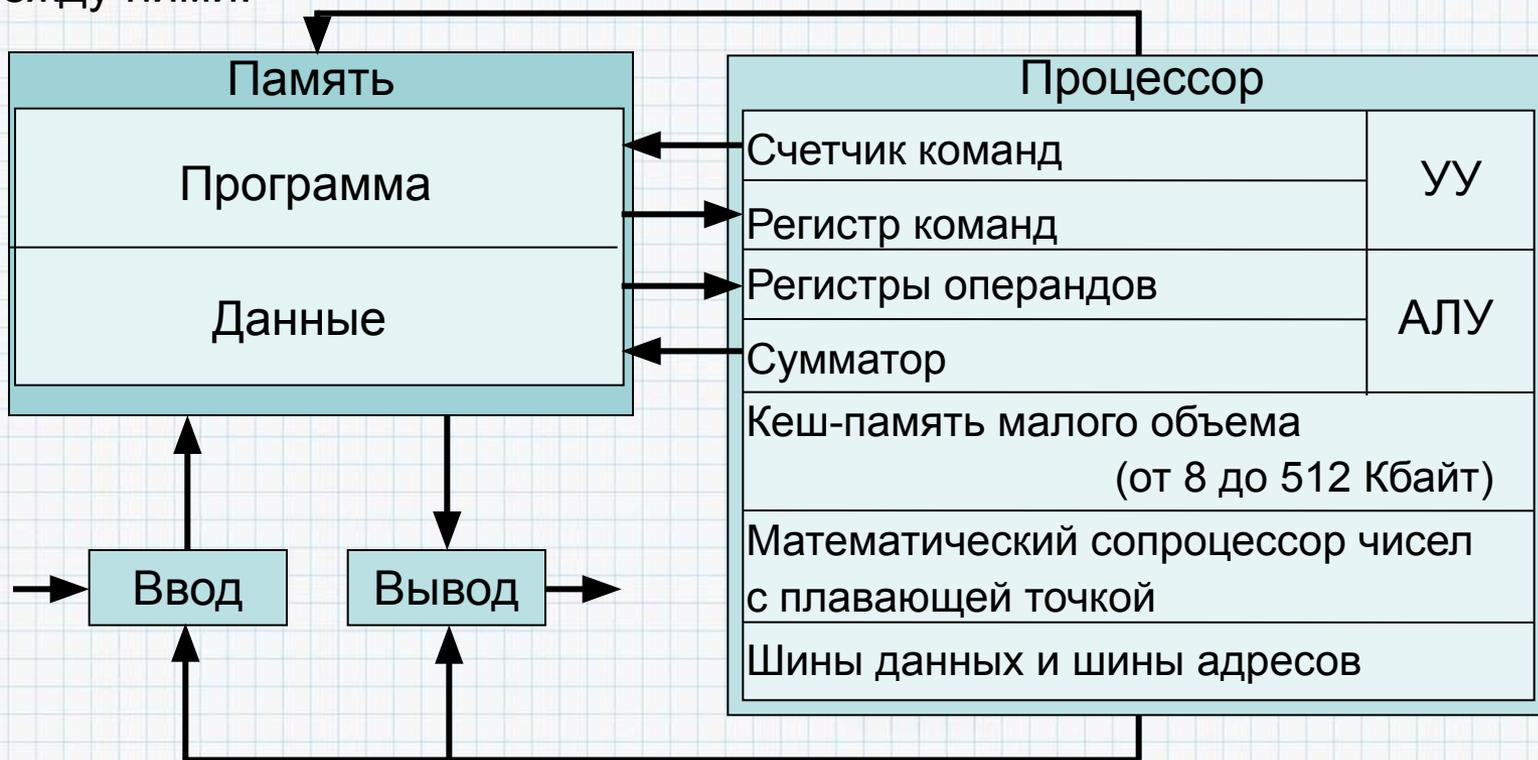
**Главные устройства** компьютера: память, процессор, устройство ввода, устройство вывода соединены **каналами связи**, по которым передается информация. На схеме жирными стрелками показаны пути и направления движения информации, пунктирными – пути и направления передачи управляющих сигналов.
