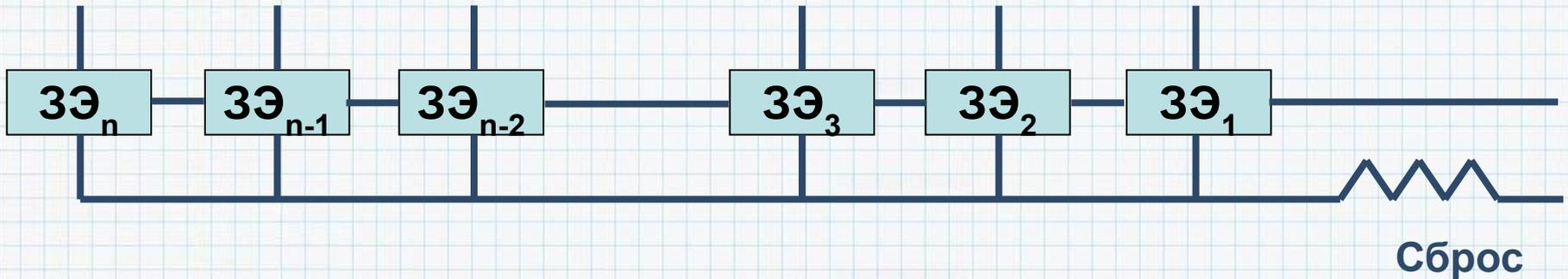
Все 3Э регистра-счетчика соединены в последовательную цепочку. Первоначальное состояние всех 3Э равно 0, что достигается подачей импульса гашения по шине «Сброс».
