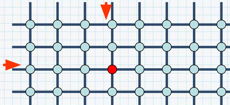
Для обеспечения избирательного доступа к любому из ЗЭ, их помещают в узлы матрицы. Для активизации конкретного ЗЭ, его подвергают одновременному действию двух токов или напряжений, поданных в одну горизонтальную и одну вертикальную шины.
