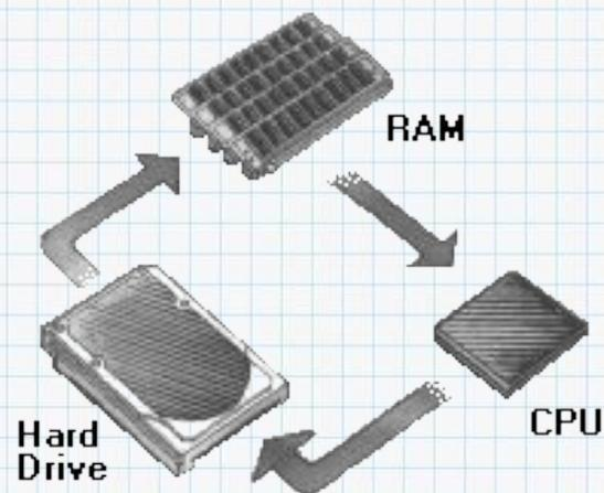
Оперативная память компьютера состоит из большого количества ячеек, в каждой из которых может храниться определенный объем информации. В современных персональных компьютерах количество ячеек памяти достигает десятков миллионов.
