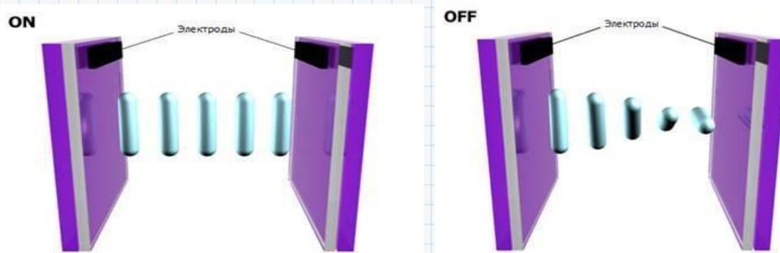
Если расположить **большое число электродов**, которые создают **разные электрические поля в отдельных местах экрана (ячейки)**, то появится возможность при правильном управлении потенциалами этих электродов отображать на экране буквы и другие элементы изображения.
