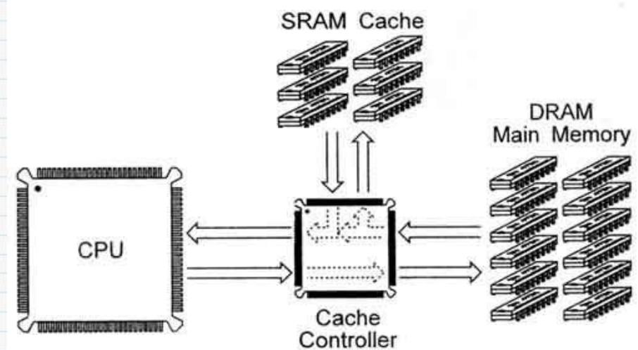
Кэш-памятью управляет специальное устройство — **контроллер**, который, анализируя выполняемую программу, **пытается предвидеть, какие данные и команды вероятнее всего понадобятся в ближайшее время процессору, и подкачивает их в кэш-память.**
