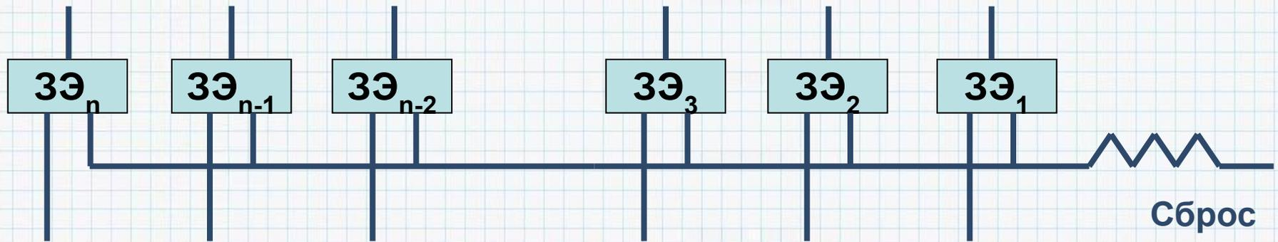
Первоначальное состояние всех 3Э равно 0, что достигается подачей импульса гашения по шине «Сброс».
