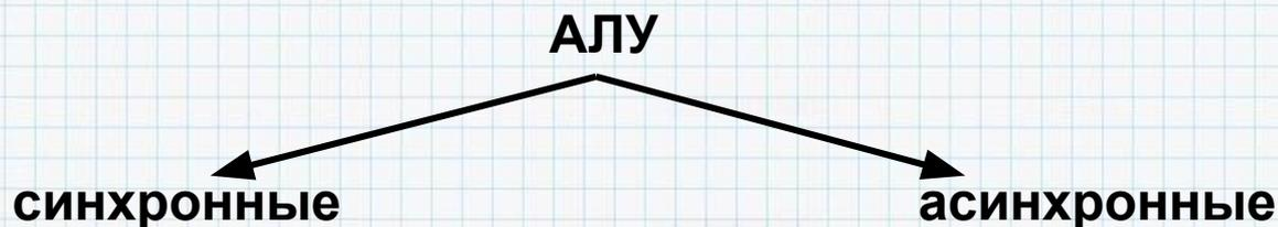
В синхронных АЛУ на выполнение каждой операции отводится одно и то же фиксированное время, определяемое длиной самой временемемкой операции.
