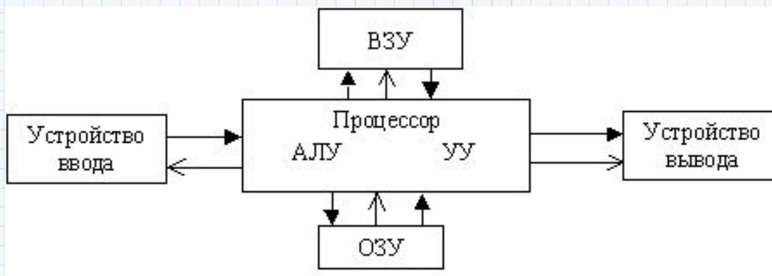
Это **однопроцессорный** компьютер. Архитектура фон Неймана использует только одну шину памяти, представляющую собой многопроводную линию с гнездами для подключения электронных схем.
