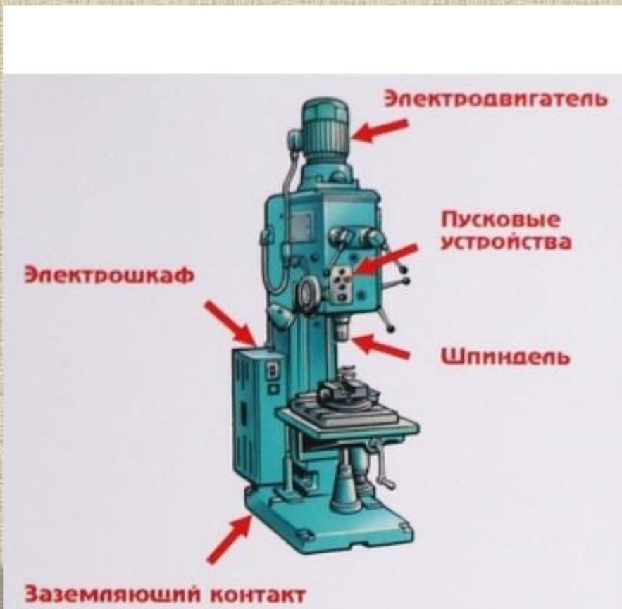
ПРИ СВЕРЛЕНИИ ВЯЗКИХ МЕТАЛЛОВ НЕ ДОПУСКАЙТЕ ОБРАЗОВАНИЯ СЛИВНОЙ СТРУЖКИ. ИСПОЛЬЗУЙТЕ СВЕРЛА С КАНАВКАМИ НА РЕЖУЩИХ ГРАНЯХ
