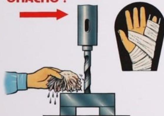
Подавать охлаждающую жидкость на сверло смоченными обтирочными концами **ЗАПРЕЩАЕТСЯ !**
