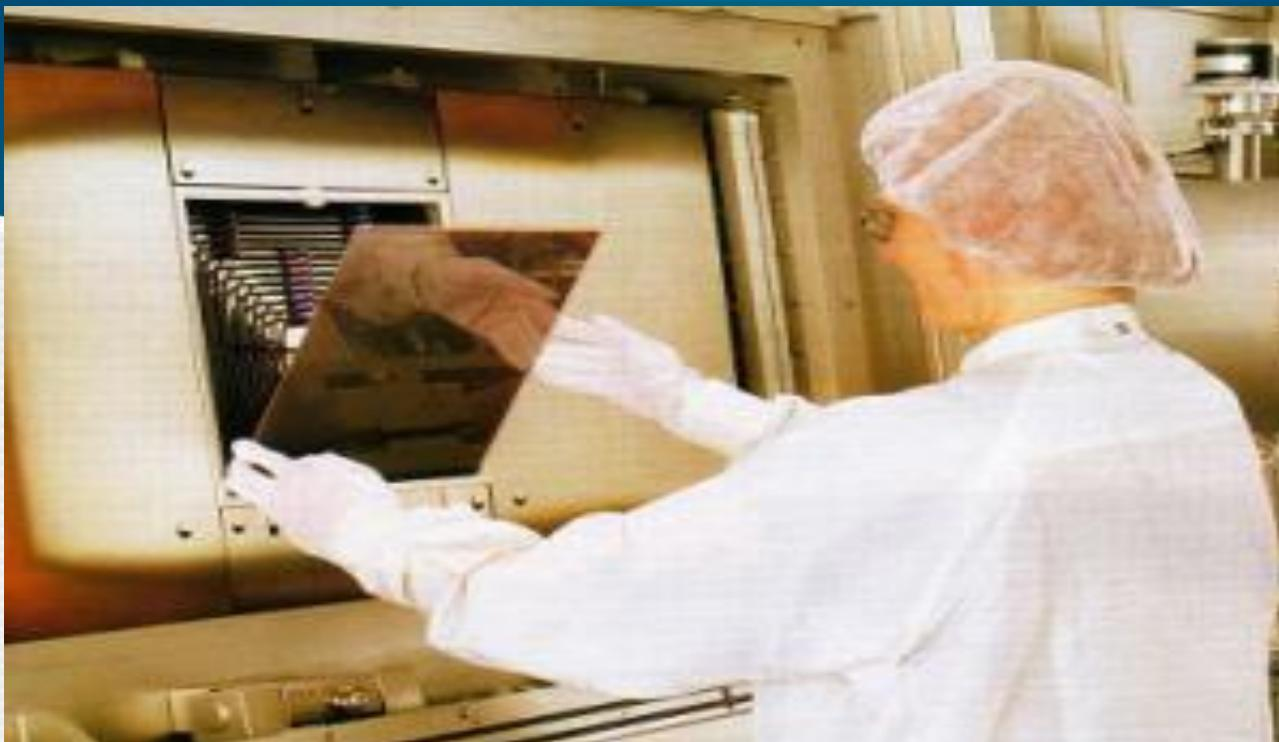
Новейшая технология нанесения металлоксидной пленки на стеклянную подложку позволяет создавать крупные тонкопленочные солнечные модули. В Америке только на один проект - строительство в пустыне Негев (Израиль) солнечной электростанции - выделено 100 миллионов долларов.
